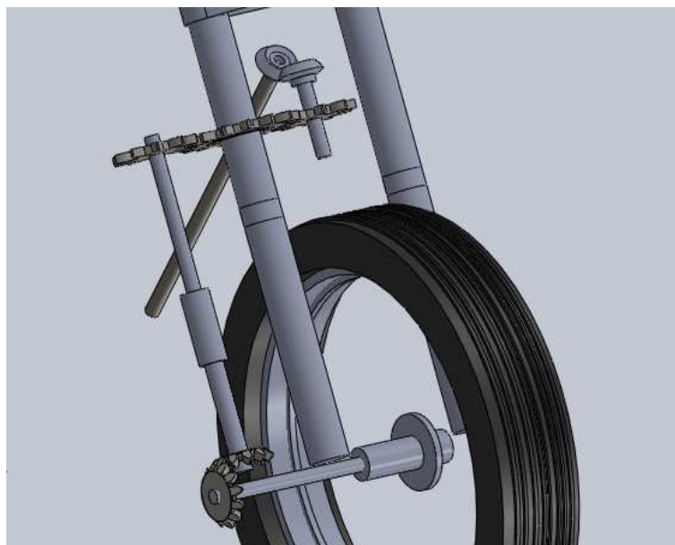
Figura 3 - 2.- Mecanismo de Tracción Delantera unido a los Telescópicos (Bosquejo) 41
