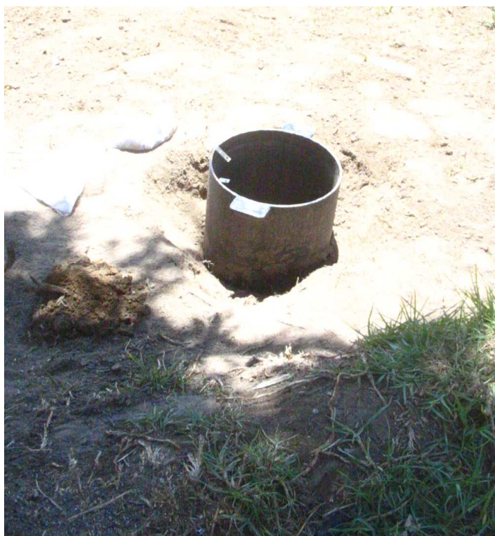
Fotografía 2 Prueba de infiltración, realizada en la población de Pusuquí, tanque IEOS. El material corresponde a suelo limo arenoso, con un valor de K=1.467 m/día
