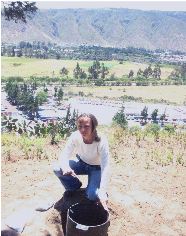
Fotografía 3 Prueba de infiltración, realizada en las laderas del volcán Catequilla, al noreste de la urbanización La Pampa. El material corresponde a suelo limo arenoso, con un valor de K=1.455 m/día
