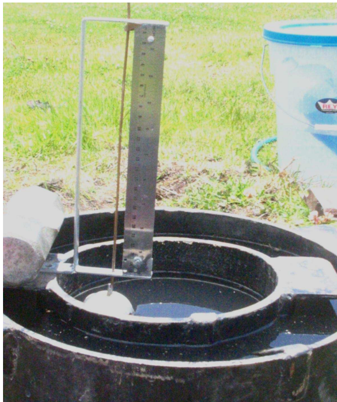
Fotografía 1 Prueba de infiltración, realizada en la población de San Antonio de Pichincha. El material corresponde a suelo limo arenoso, con un valor de K=1.455 m/día
