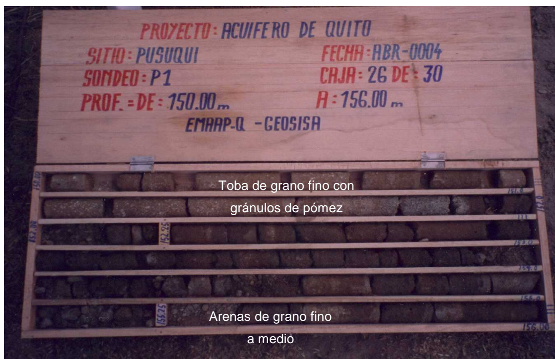
Fotografía 4 Secuencia de los Depósitos Casitagua
