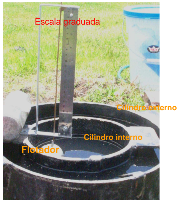
Figura 3.2 Prueba con Infiltrómetro de doble cilindro o doble anillo
