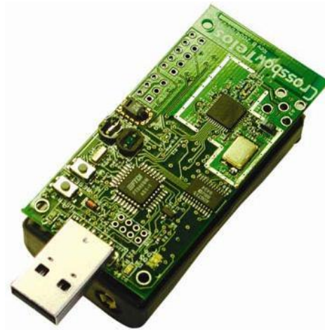
Fig 3. TRP2420(TelosB) con pack de baterías AA [9].
