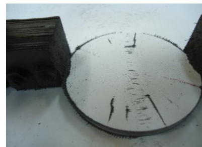
Fig. 26 Fisuras detectadas por el método de partículas magnéticas secas con corriente rectificad de media onda a 0°
