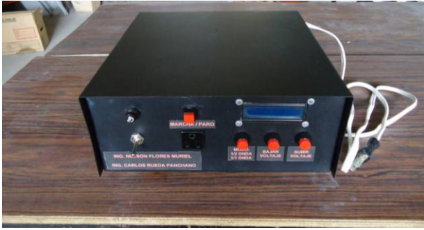
Fig. 33 Módulo de control de corriente para los yugos electromagnéticos
