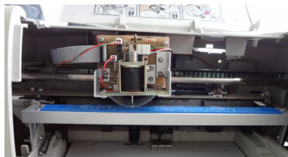
Fig. 3. Módulo punzón fijado al carrete de la impresora
