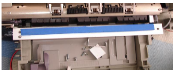
Fig. 25. Reemplazo de la Bandeja de Apoyo de Impresión
