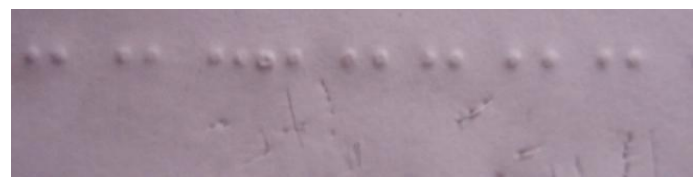
Fig. 21. Pruebas de impresión con el punzón basado en el principio de taladrado
