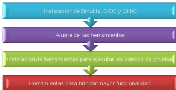
FIGURA 5. SUBPROCESOS INVOLUCRADOS EN LA CONSTRUCCIÓN DEL SISTEMA TEMPORAL
