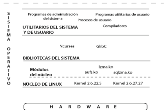
FIGURA 2. CAPAS DEL SISTEMA OPERATIVO
