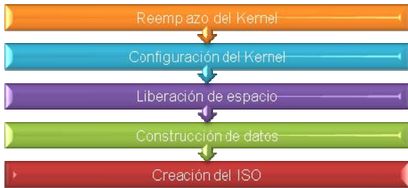
FIGURA 8. PROCESOS INVOLUCRADOS EN LA CREACIÓN DEL LIVECD
