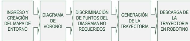
Fig 10. Diagrama de bloques de la programación
