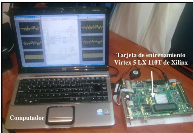
Fig. 21 Equipos utilizados para el desarrollo de las pruebas
