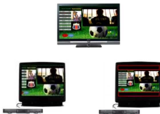
Fig. 4. Formas de visualización de una aplicación en un televisor analógico vs. uno digital
