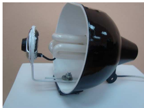
Fig. 4. Sistema de iluminación difuso.
