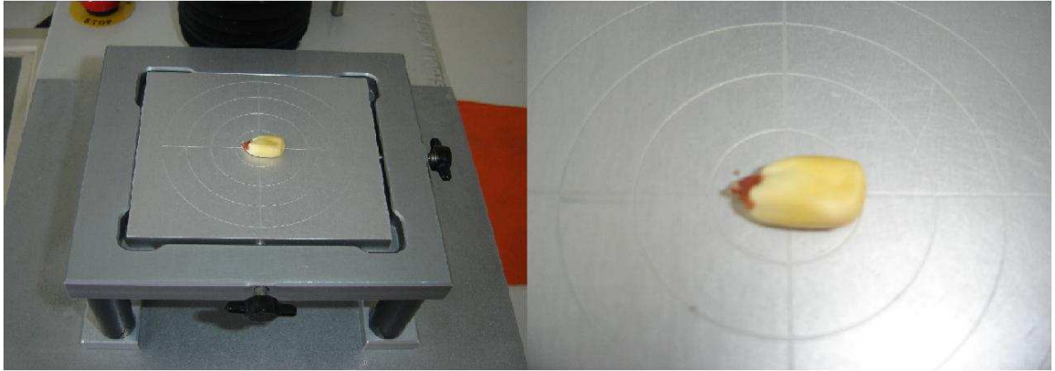
Figura A.1. Grano de maíz sobre la plataforma del Texturómetro TA-XT2.
