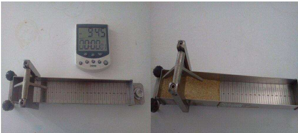
Figura 15. Determinación de consistencia Bostwick de una suspensión de maíz tostado en microondas.
