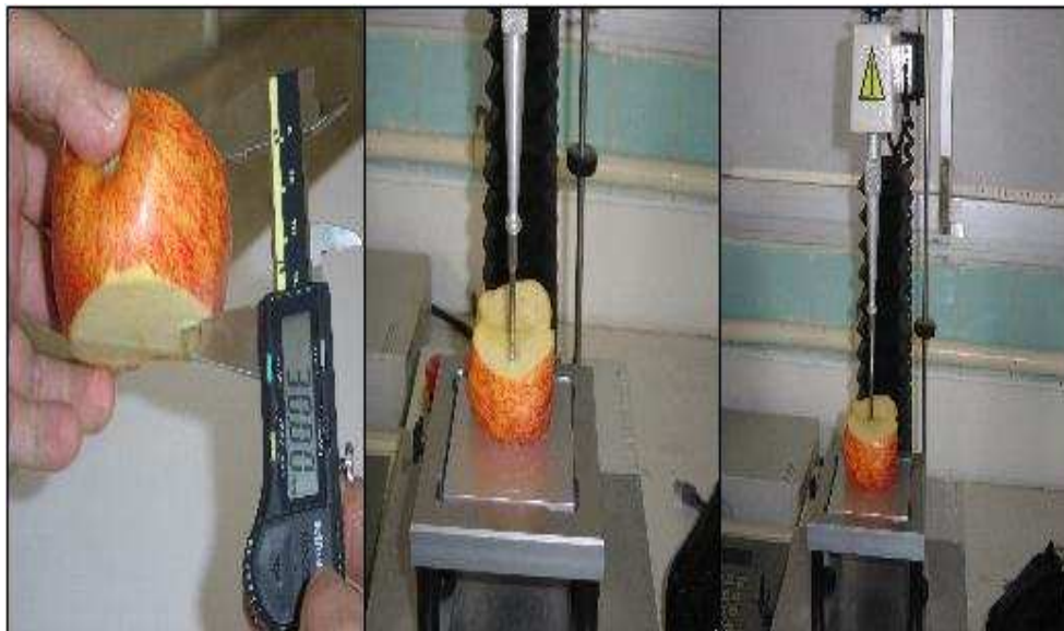
Figura 2.2. Mediciones de textura en manzana cruda en el Texturómetro TA-XT2i
