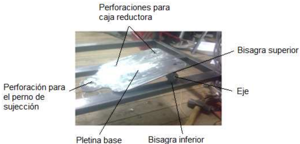
Figura 3.10 Montaje de pletina base.
