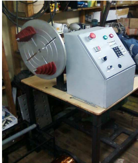
Figura 4.6 Máquina rebobinadora semiautomática.
