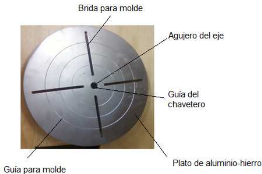
Figura 3.16 Partes del plato de brida.
