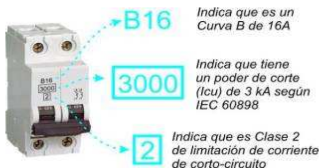
Figura 1.23 Frente de un interruptor de riel con identificaciones obligatorias 39
