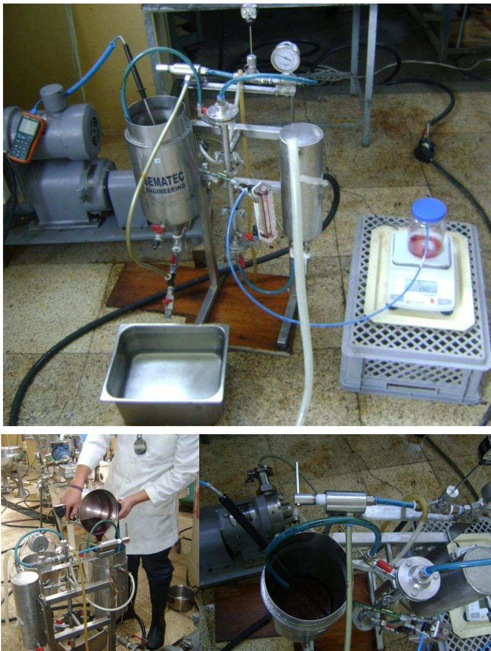
Figura A.7 Equipo de microfiltración tangencial SEMATEC a escala de laboratorio
