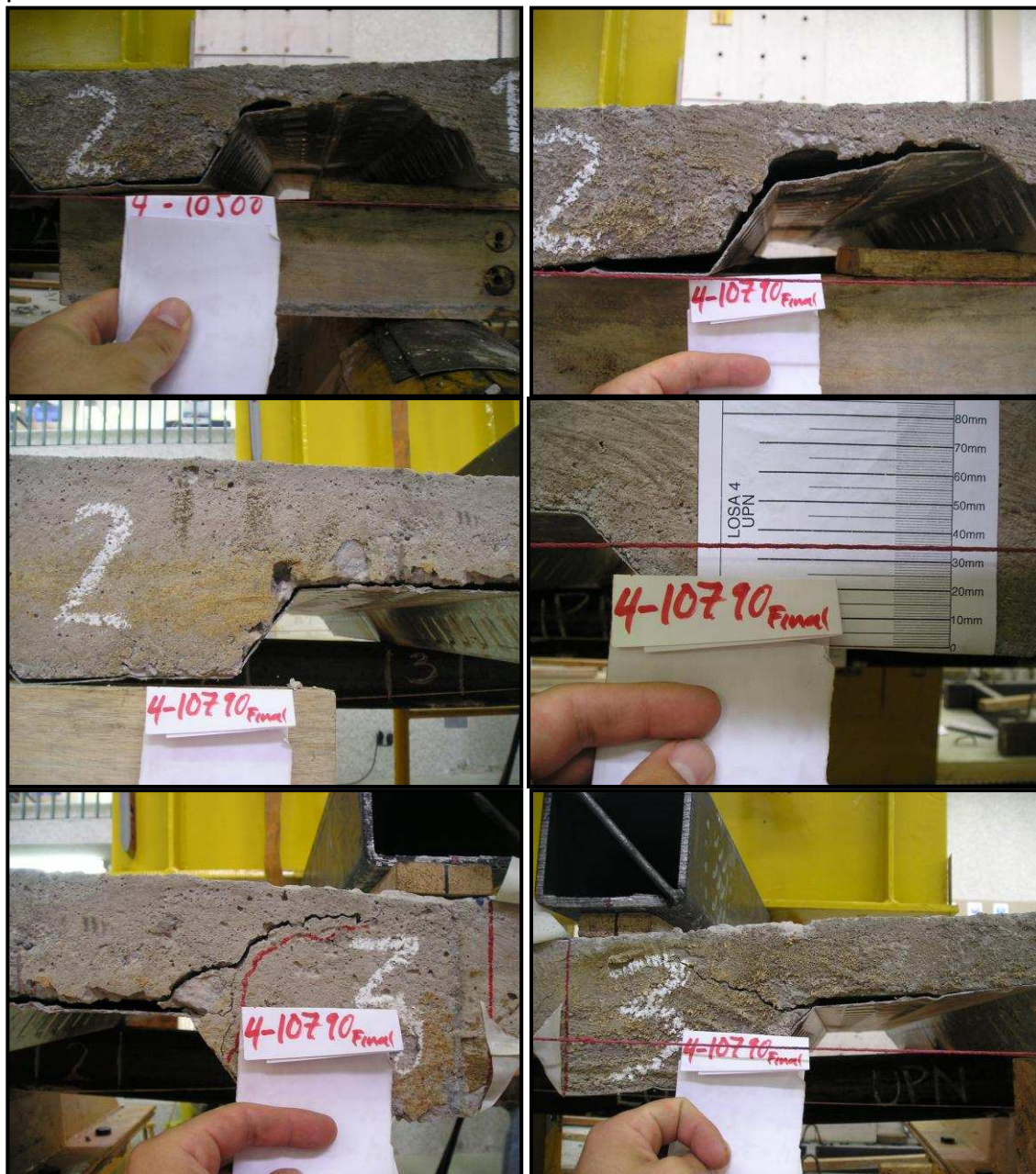
FOTO 4.16. RESULTADOS FINALES DE LA SECCIÓN COMPUESTA YA APLICADA TODOS LOS CICLO DE CARGA
