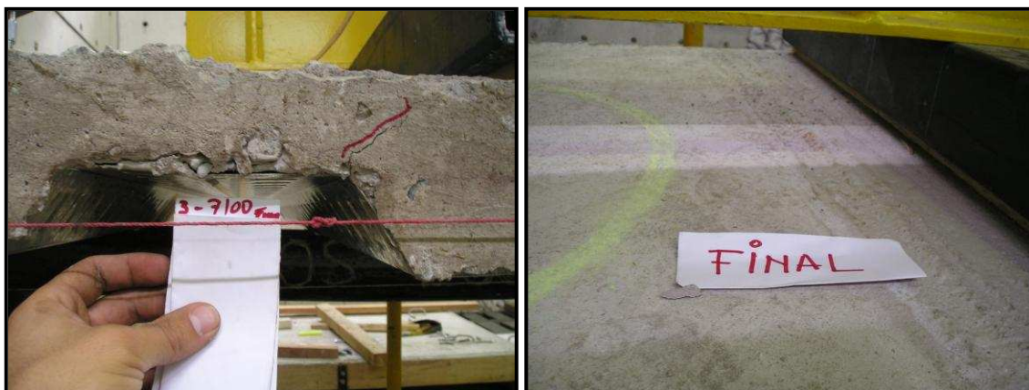
FOTO 4.12. RESULTADOS FINALES DE LA SECCIÓN COMPUESTA UNA VEZ APLICADA TODOS LOS CICLOS DE CARGA
