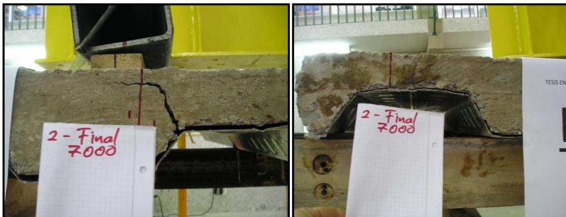
FOTO 4.8. RESULTADO FINAL UNA VEZ APLICADA TODOS LOS CICLOS DE CARGA.
