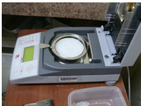
Figura 2.9. Pellets de polipropileno en el analizador de humedad.
