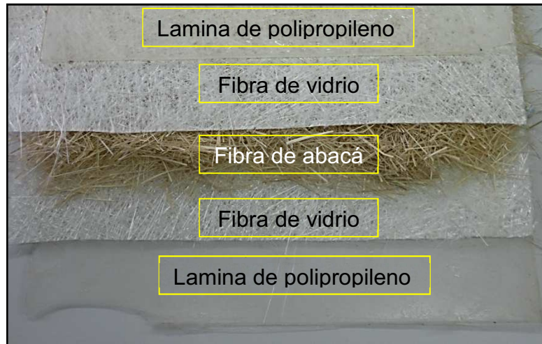
Figura 2.14. Preparación del material compuesto híbrido tipo sánduche.
