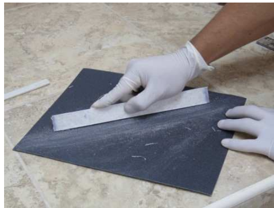
Figura 2.19. Lijado de probetas de tracción con lija # 240.
