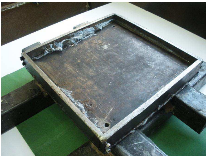
Figura 3.1. Fugas de PP por las uniones del molde.
