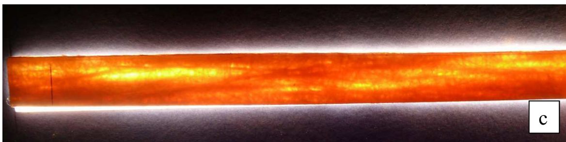
Figura 3.14. Probeta para ensayo de flexión al 25 vol% de refuerzo híbrido de 50% de fibra de abacá longitudinal unidireccional y 50% fibra de vidrio.
