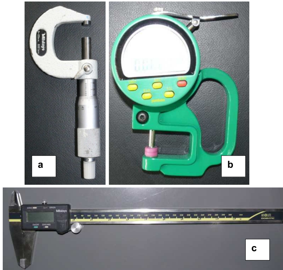
Figura 2.4. Instrumentos de medición: (a) micrómetro, (b) medidor de espesores, (c) calibrador pie de rey.
