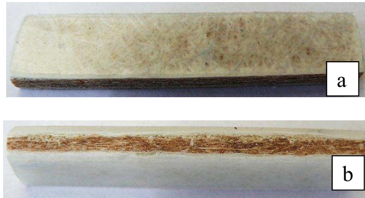
Figura 3.16. Probeta de impacto al 25 vol% de refuerzo de fibra corta de abacá de 20 mm (50% abacá / 50% fibra de vidrio).
