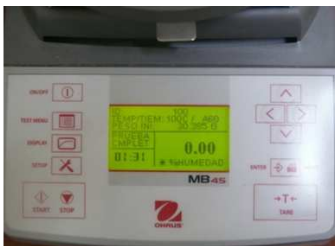
Figura 3.6. Ensayo realizado en el analizador de humedad a los pellets sin secar.
