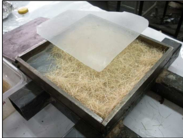
Figura 2.11. Elaboración de material compuesto conformación tipo sánduche utilizando fibra de abacá de 20 mm.
