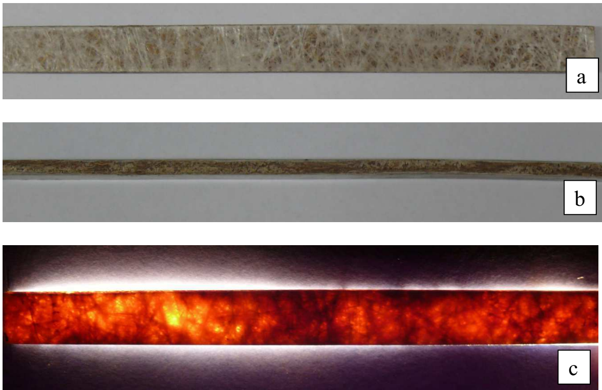
Figura 3.13. Probeta para ensayo de flexión al 25 vol% de refuerzo con fibra corta de abacá de 20 mm y 25% fibra de vidrio.
