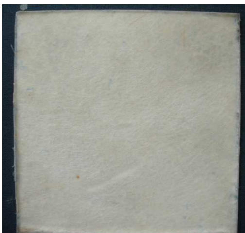
Figura 3.10. Lámina de material híbrido reforzado con 25 vol% de fibras (50% vidrio y 50% abacá).
