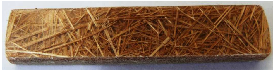
(a) Fractura completa de la matriz de polipropileno luego del ensayo de impacto.
