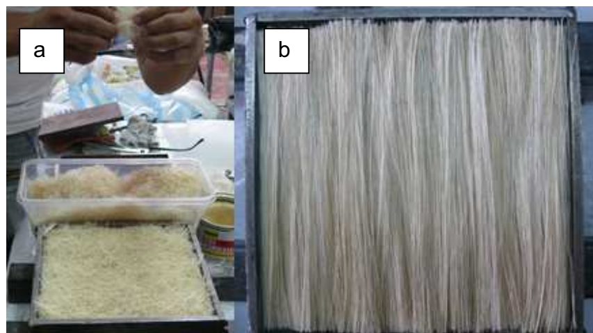
Figura 2.12. Colocación de fibra de abacá en el molde: (a) Distribución de fibra corta; (b) Distribución de fibra continua.
