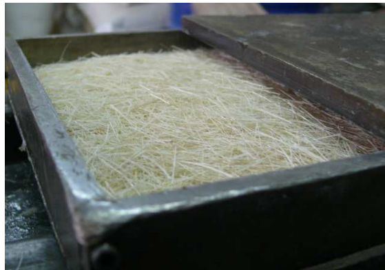
Figura 2.16. Fibra corta de abacá compactada en el molde.
