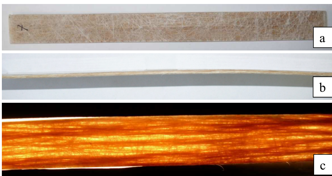
Figura 3.11. Probeta para ensayo de tracción con fibra longitudinal orientada unidireccionalmente al 20 vol% de refuerzo (75% abacá / 25% fibra de vidrio).
