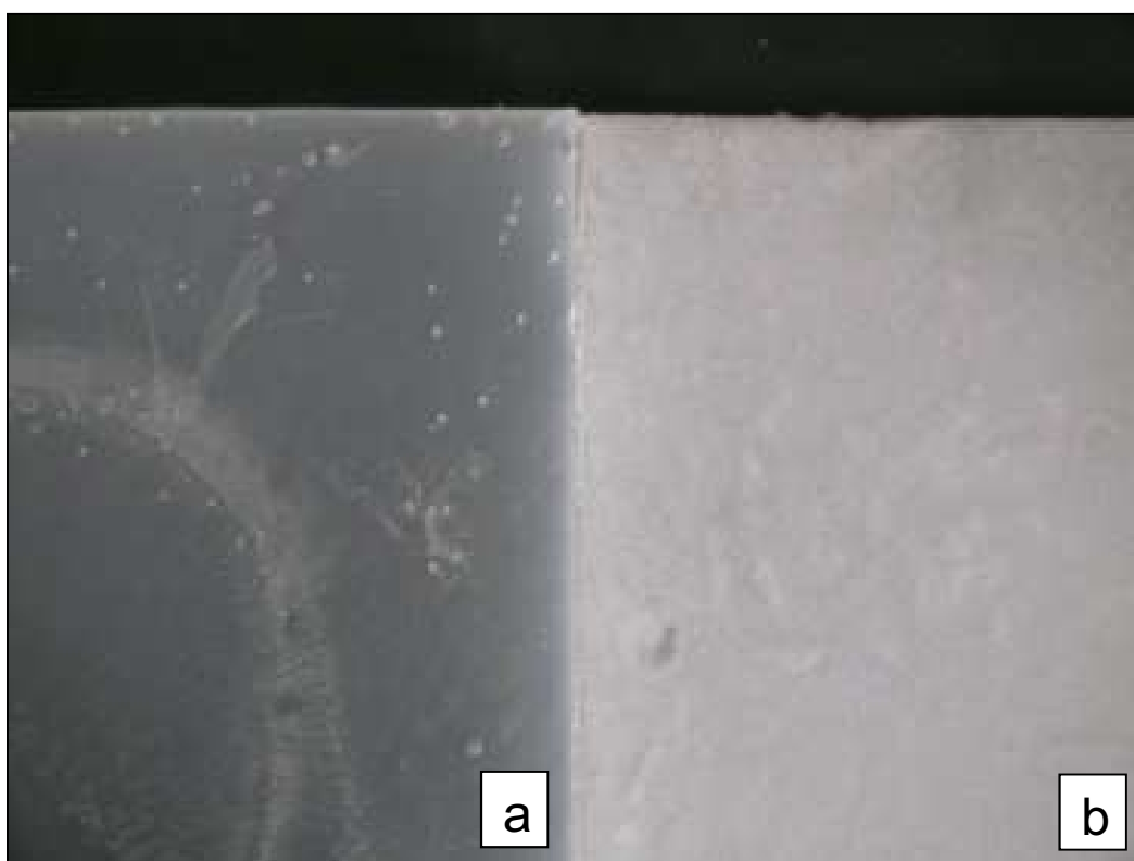
Figura 3.7. Láminas de matriz polipropileno degradada y no degradada a una presión de 23 psi. a) Tiempo de exposición a la temperatura 5 min; b) Tiempo de exposición a la temperatura 35 min (material degradado).
