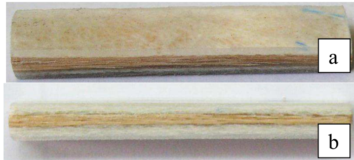
Figura 3.15. Probeta de impacto al 20 vol% de refuerzo de fibra de abacá longitudinal unidireccional (25% fibra de vidrio / 75% abacá)
