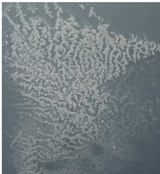
Figura 3.5. Lamina de PP con defectos de burbujas internas y líneas producidas por el flujo del material.
