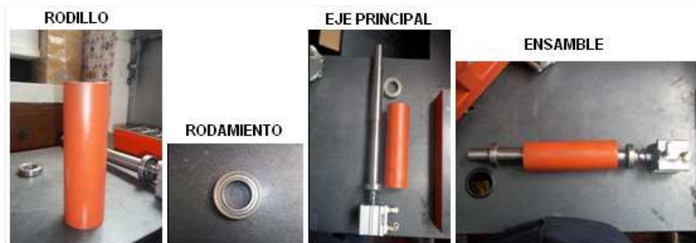
Figura 4.12 Ensamble del eje principal y rodillo.
