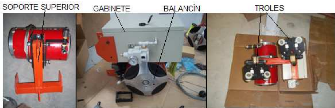
Figura 4.27 Montaje del soporte superior
