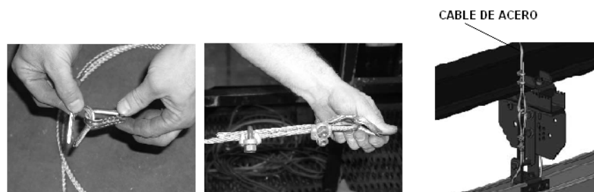
Figura 4.6 Montaje de los elementos de seguridad.
