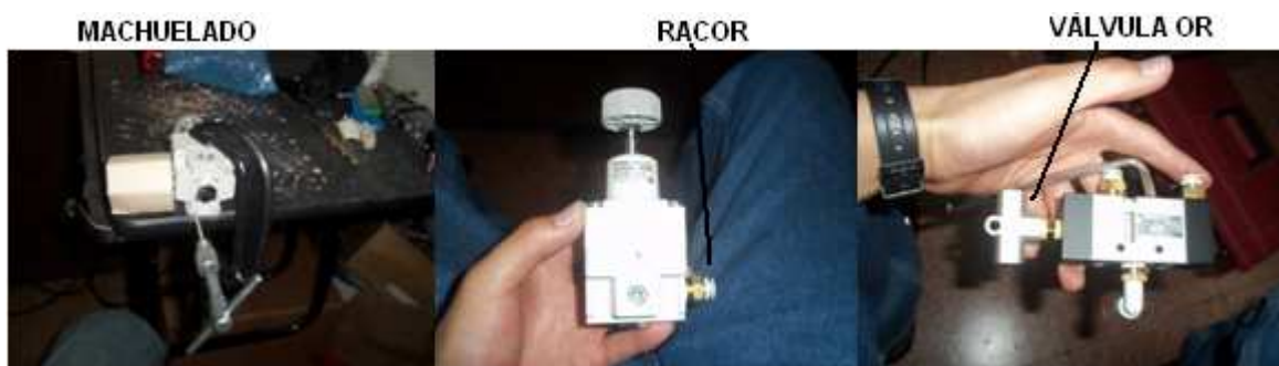
Figura 4.20 Montaje de racores y accesorios
