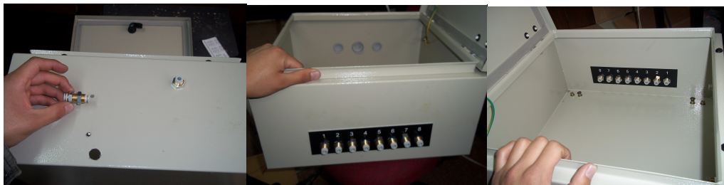
Figura 4.22 Montaje de accesorios en el gabinete
