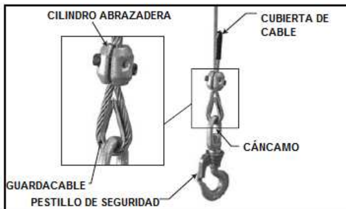
Figura 2.83 Instalación del gancho de carga
