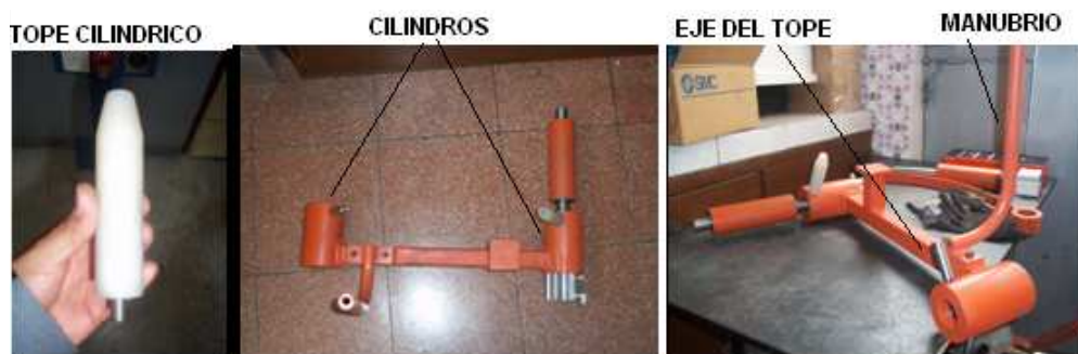
Figura 4.13 Ensamble del soporte posterior, tope cilíndrico y manubrio.
