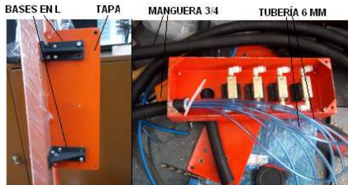
Figura 4.16 Montaje de botonera.
