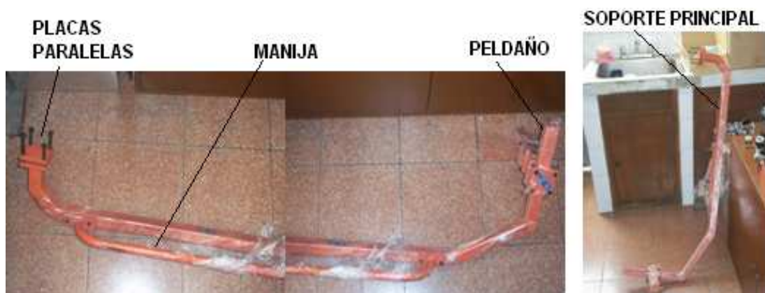
Figura 4.11 Ensamble del soporte principal, peldaño y manija.
