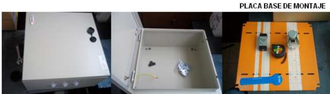
Figura 4.18 Caja térmica empleada como gabinete
