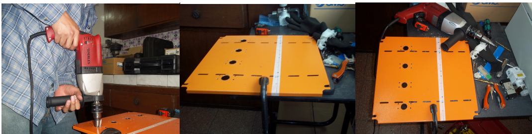
Figura 4.19 Perforaciones en la placa base
