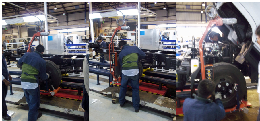
Figura 4.32 Engravidación y montaje del modelo de rueda.
