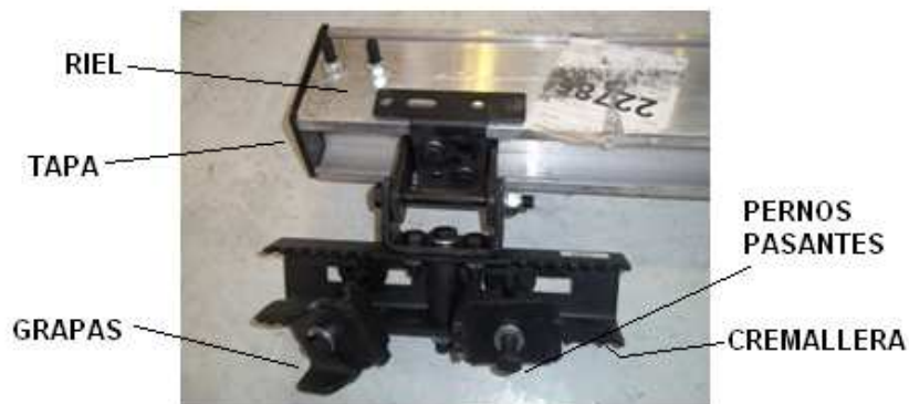
Figura 4.3 Montaje de un suspensor en un Riel.
