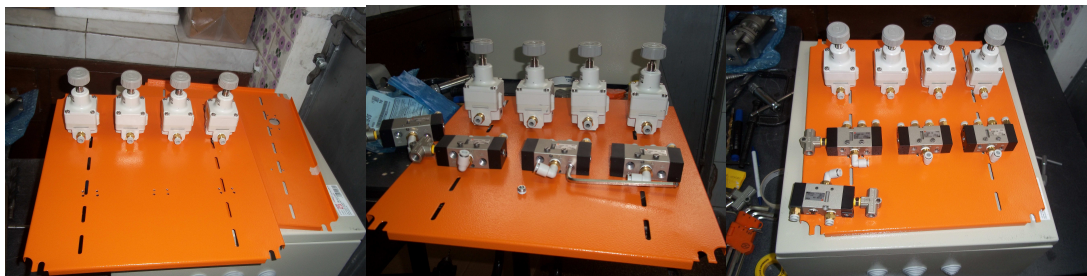
Figura 4.21 Montaje de reguladores y válvulas a la placa base
