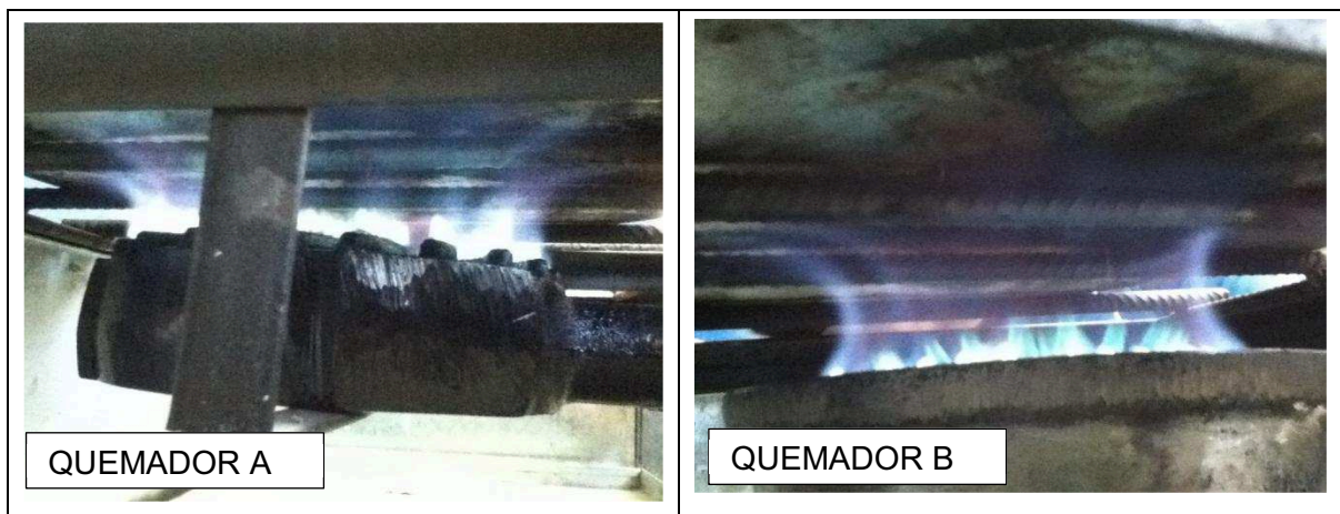
Figura 5. 4. Distribución de la llama en los quemadores de fundición gris.
