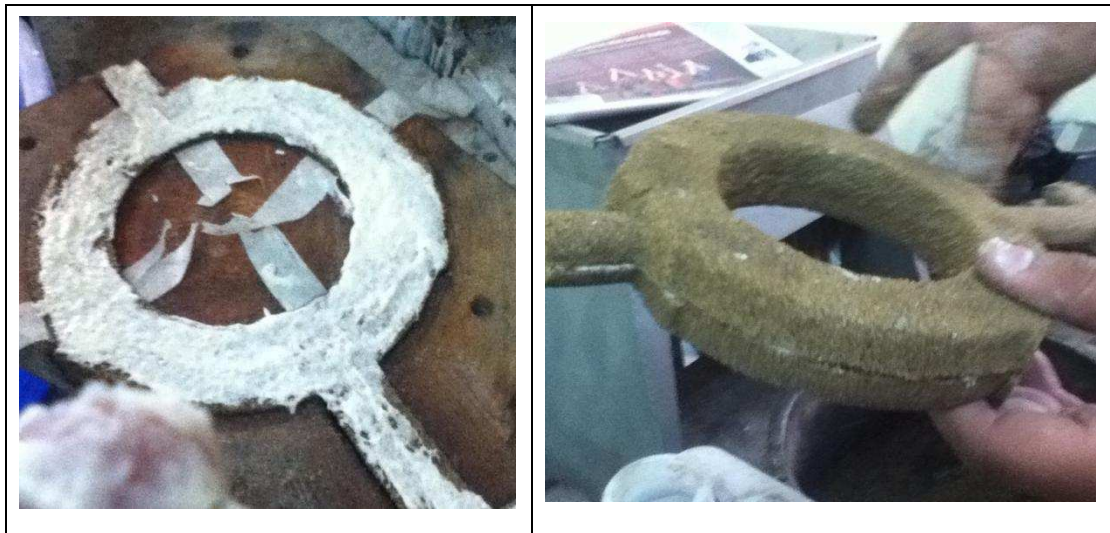
Figura 4. 17. Ensamble del noyo del quemador A.
