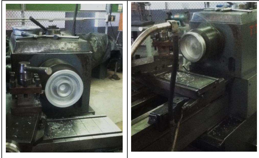
Figura 4. 37. Torneado del quemador B.
