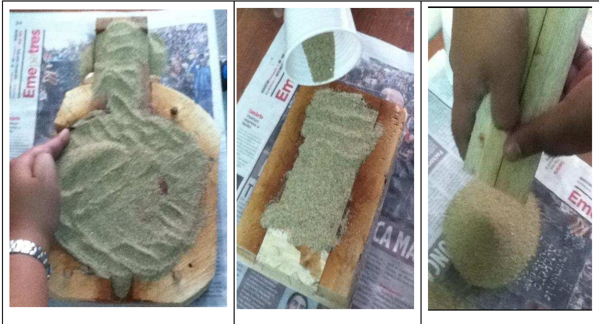
Figura 4. 14. Estimación de la cantidad de arena para la mezcla de moldeo de noyos.
