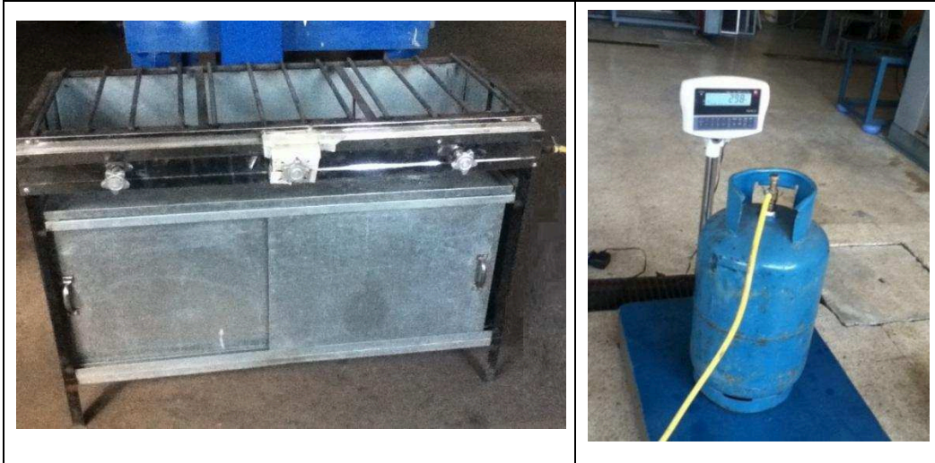
Figura 2. 5. a) Cocina industrial utilizada para el ensayo b) Tanque de gas convencional montado sobre balanza digital.
