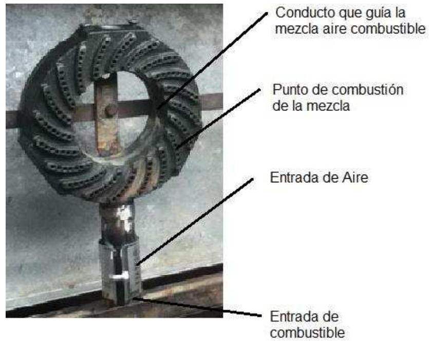
Figura 1. 5. Partes de un quemador de cocina industrial.
