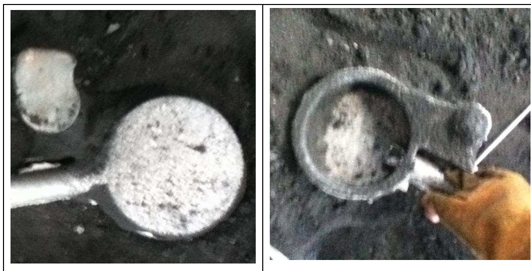
Figura 4. 32. Cacerola del quemador B obtenida por fundición.
