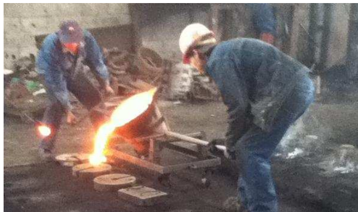
Figura 4. 30. Colado en los moldes.
