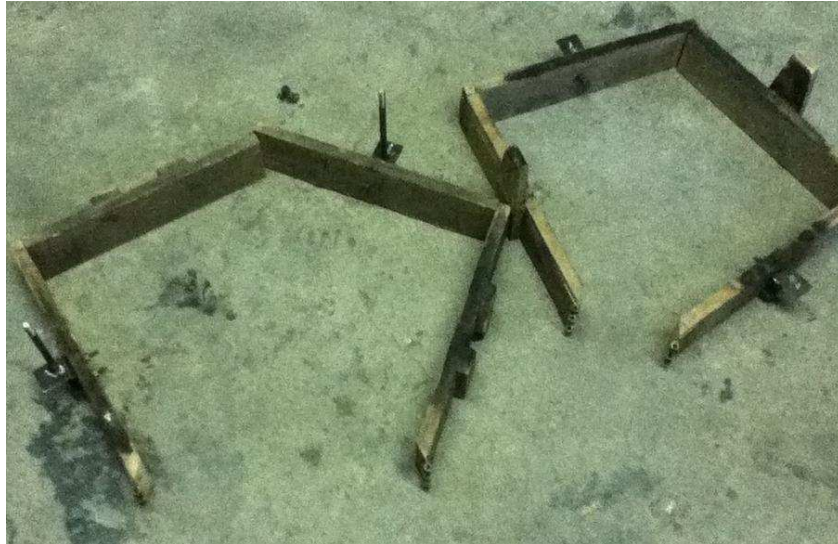
Figura 4. 21. Cajas desmontables abiertas.
