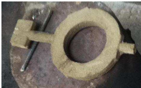
Figura 4. 18. Noyo del quemador A terminado.
