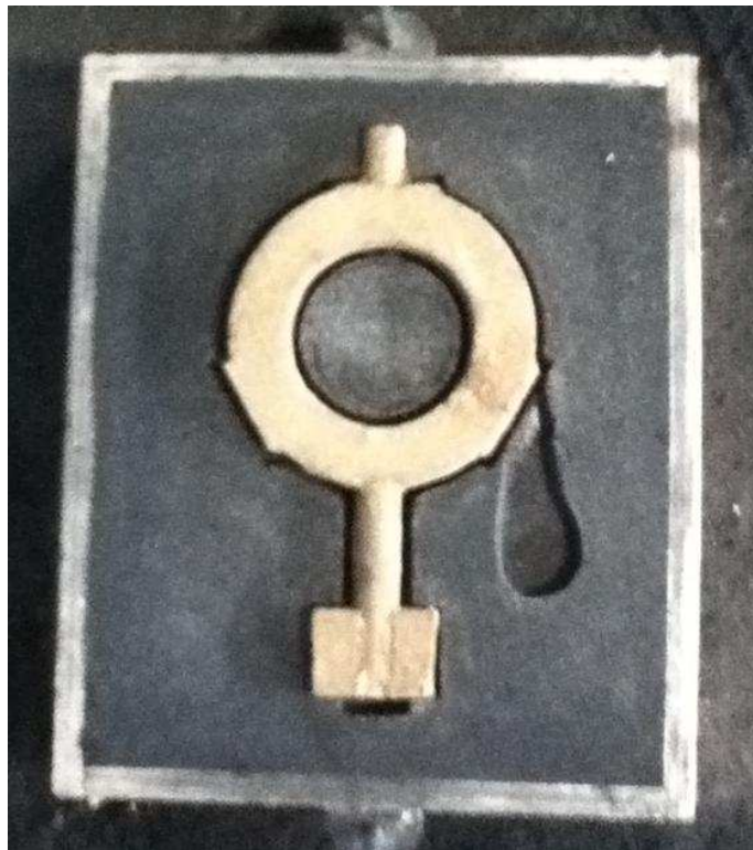
Figura 4. 26. Montaje del noyo en el molde del quemador A.
