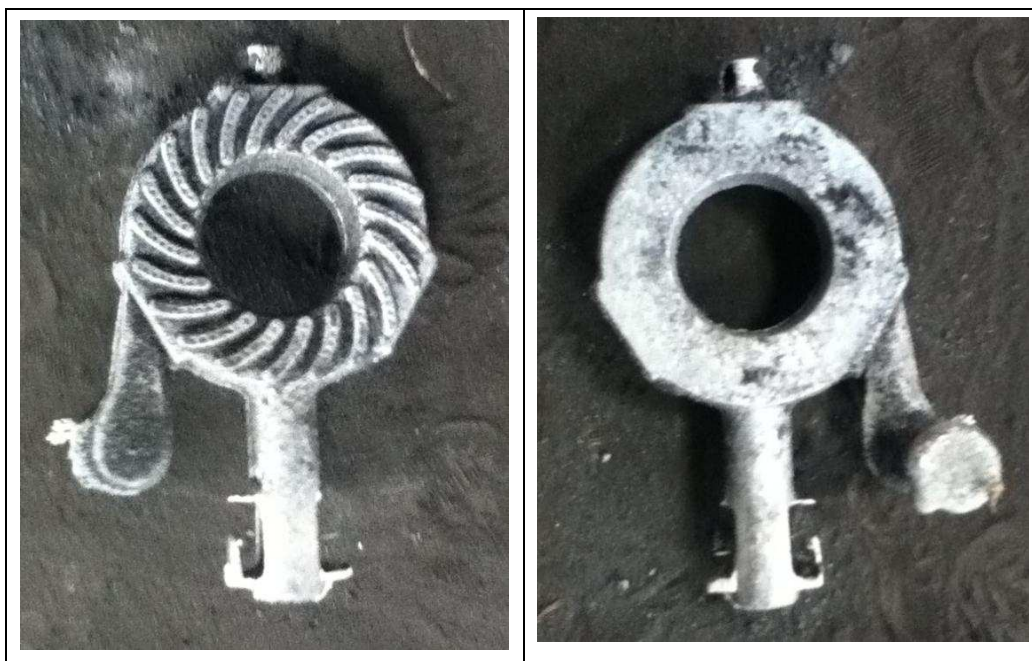
Figura 4. 31. Quemador A obtenido por fundición.
