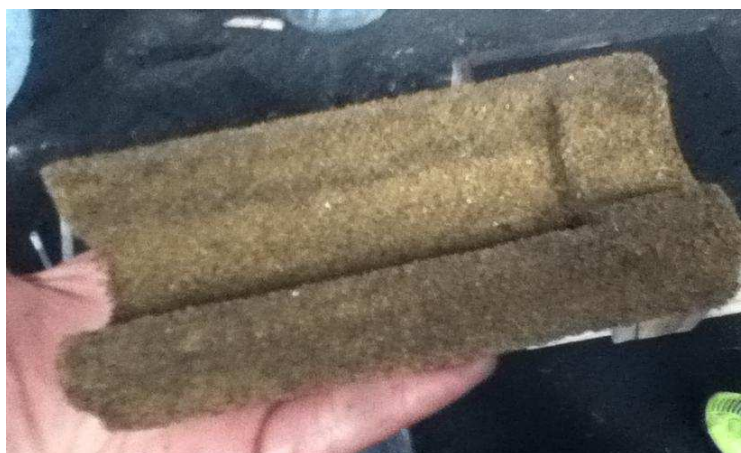
Figura 4. 20. Noyo externo de la cacerola del quemador B terminado.
