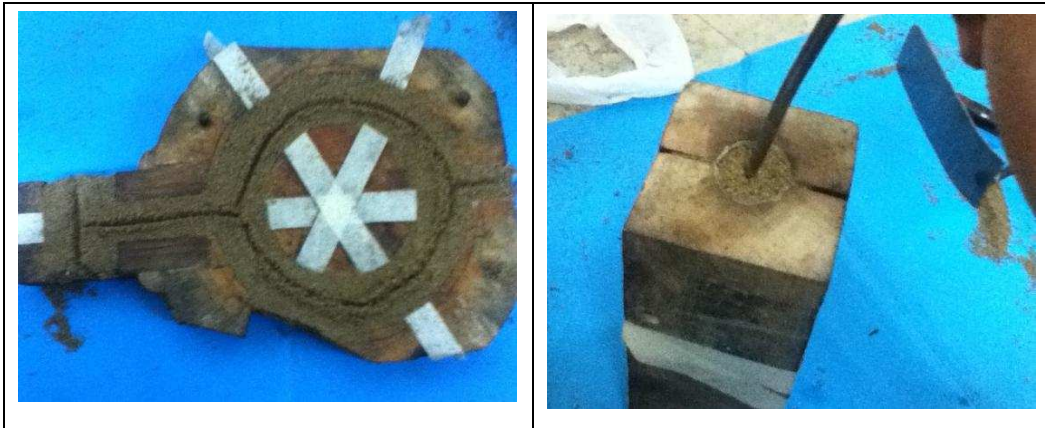
Figura 4. 16. Canales de ventilación.
