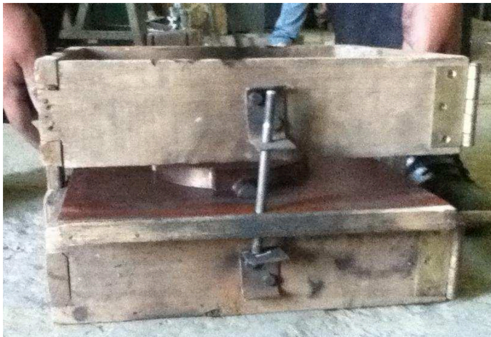
Figura 4. 23. Ensamble de la caja desmontable con la placa modelo.
