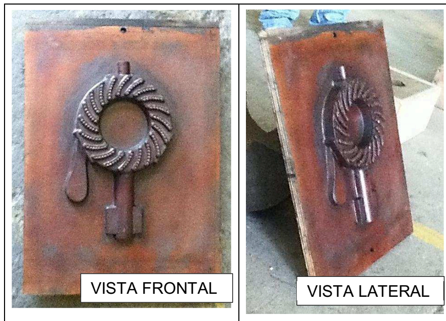
Figura 4. 3. Parte inferior del quemador A.
