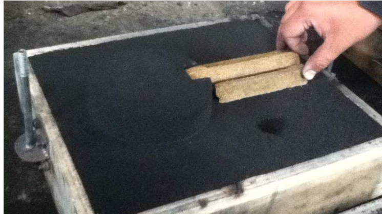
Figura 4. 27. Montaje del noy en el molde de la cacerola del quemador B.
