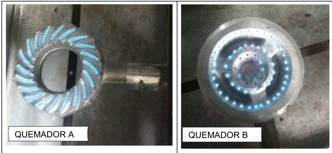
Figura 5. 3. Distribución de la llama en los quemadores de aluminio.
