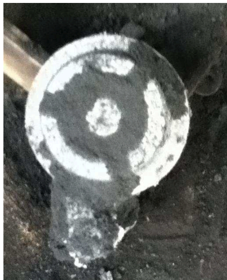
Figura 4. 33. Tapa del quemador B obtenida por fundición.
