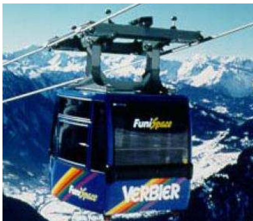
Figura 1.8 Sistema de teleférico de doble anillo.
