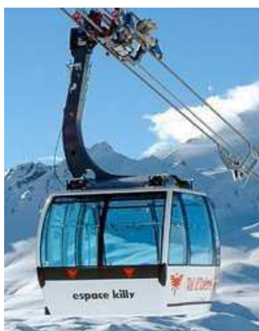
Figura 1.9 Sistema de teleférico bicable.
