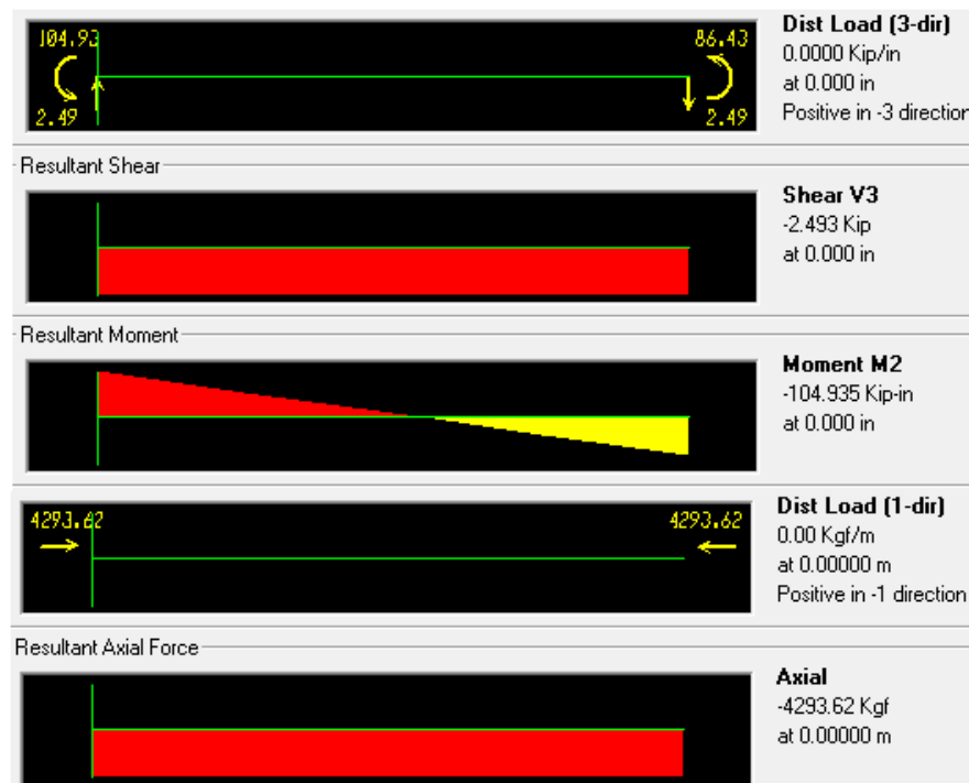
Figura 3.19 Estado de carga crítica del brazo de la rueda.
