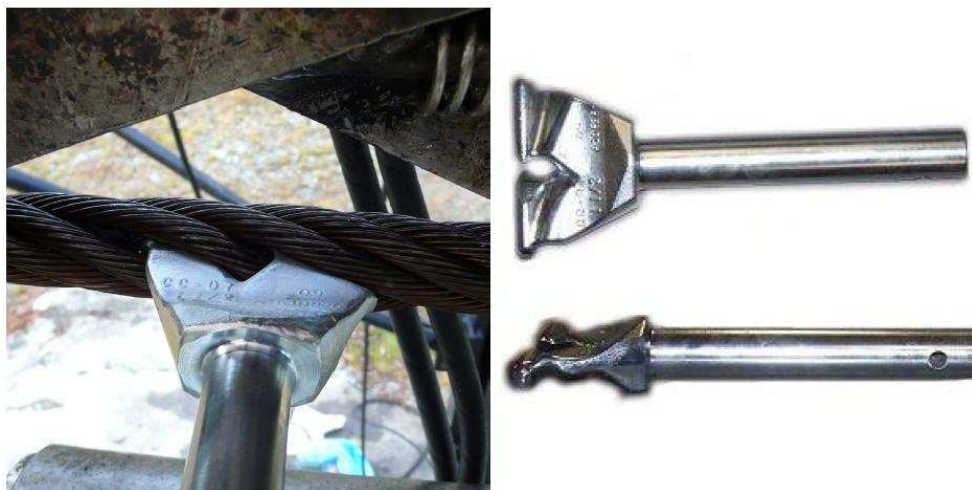
Figura 6.12 Funcionamiento del gancho de sujeción
