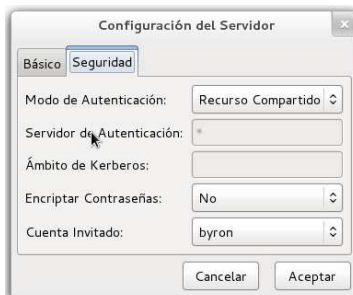
Figura 2.53 Configuración de encriptación y autenticación en Samba.
