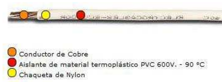
Figura: 2.4 Detalles del conductor de cobre tipo THHN 7
