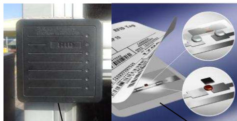
Figura: 5.8 Dispositivo de control de acceso y tarjeta RFID
