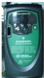
Figura: 2.24 Variador de velocidad
