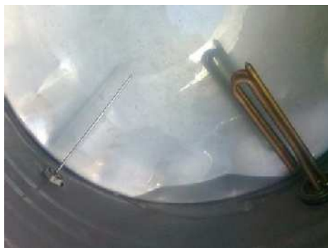
Figura 3.25- Colocación de los instrumentos en el tanque.
