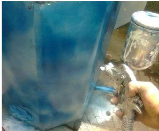
Figura 3.31- Pintado del calentador de agua.
