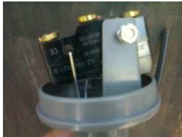
Figura 3.18- Activación del switch
