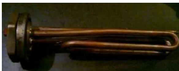
Figura 3.13- Niquelina comercial usada en el proyecto.
