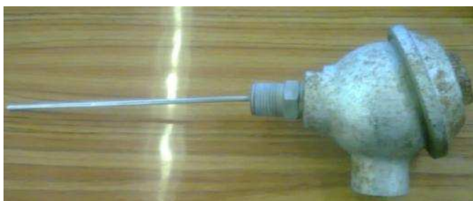
Figura 3.14- RTD usada en el proyecto.
