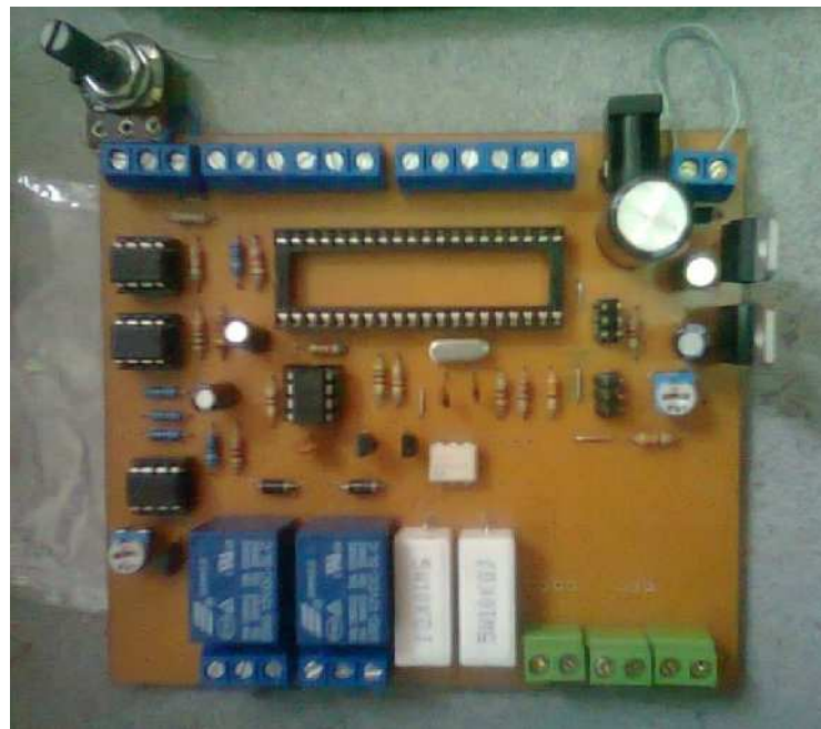
Figura 4.14- Circuito de control soldado.
