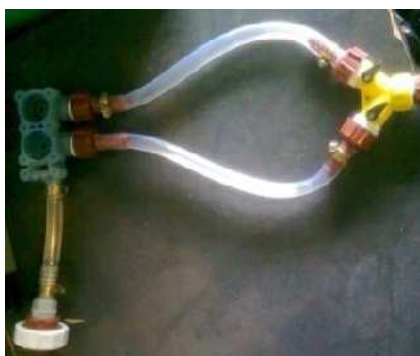
Figura 3.30- Entrada de agua al calentador.
