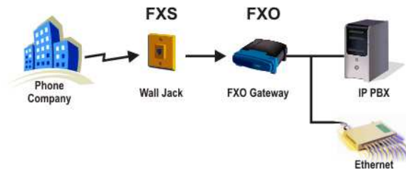
Figura 3.16 Diagrama básico de conexión del servidor de voz IP [PW69]
