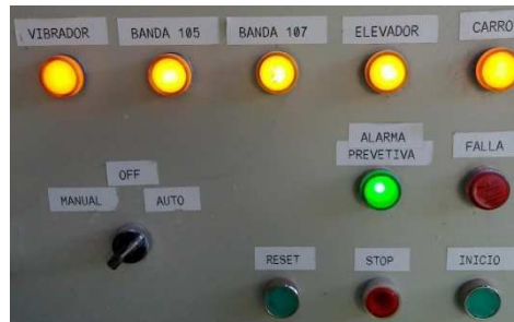
Figura 4.24 Inicio de Secuencia de Arranque
