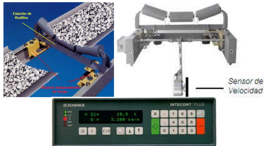
Figura 1.19 Báscula de Cinta tipo BEMP (Celdas de Pesaje, Sensor de Velocidad y Electrónica), tomado de [5]
