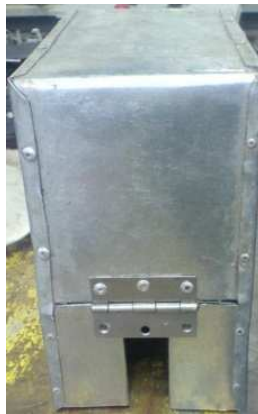
Figura 4.47 Carcasa de Protección del Sensor de Nivel
