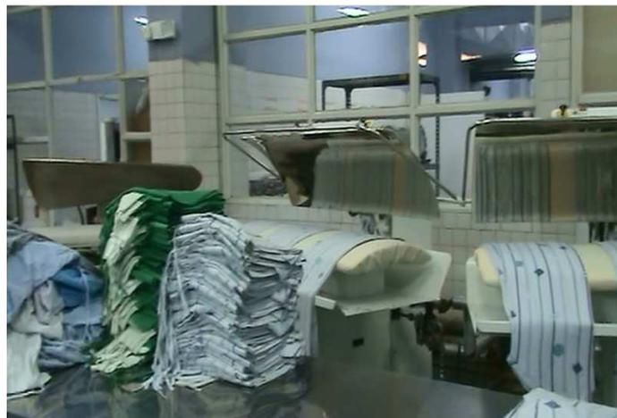
**Fotografía 2. 13** Planchadora tipo prensa [Fuente: propia]
