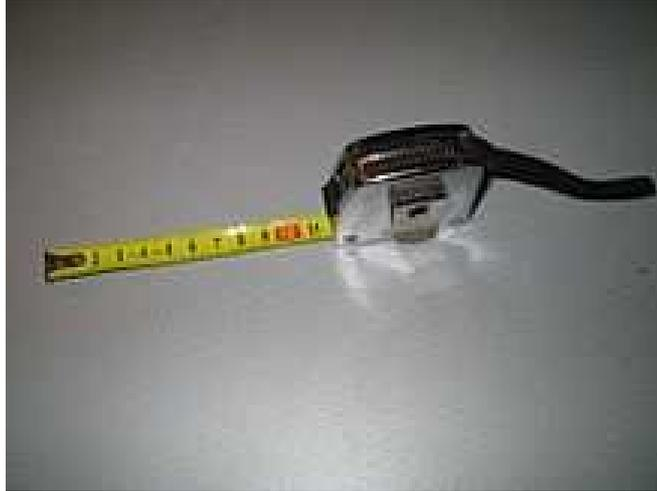
El flexómetro es un instrumento de medición el cual es coincido con el nombre de cinta métrica, con la particularidad de que está construido por una delgada cinta metálica flexible, dividida en unidades de medición, y que se enrolla dentro de una carcasa metálica o de plástico.
