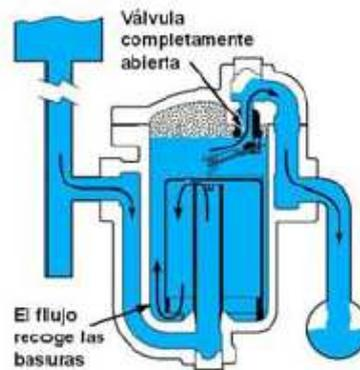
**Figura 2. 9** Forma de operación balde invertido (a)<sup>22</sup>
