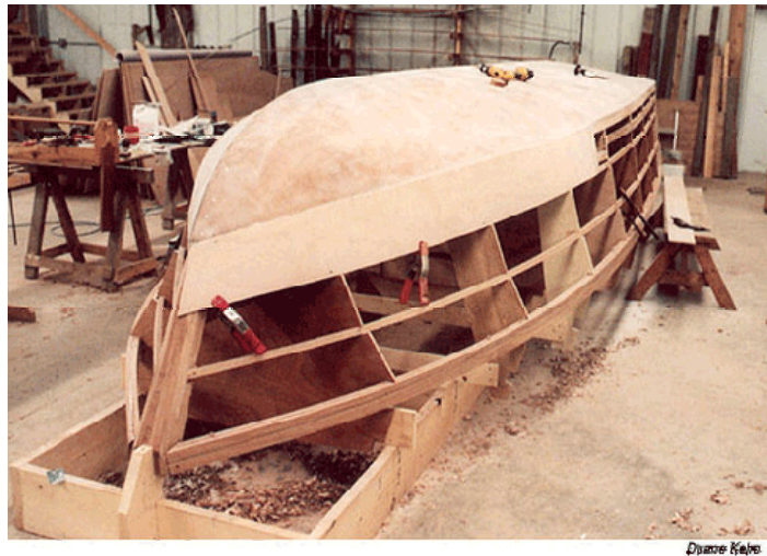
Fig. 1.3: Estructura de un bote de madera en construcción mostrando el esqueleto interno 3
