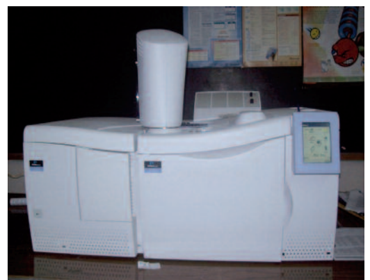
Figura 2. Cromatógrafo de gases acoplado a un espectrómetro de masas (GC/MS) Clarus 500 de Perkin Elmer, donde se realizó la identificación y cuantificación de los 16 HAP's considerados como contaminantes prioritarios por la EPA, a partir de vísceras y músculos de peces y sedimentos de la zona de Shushufindi.
