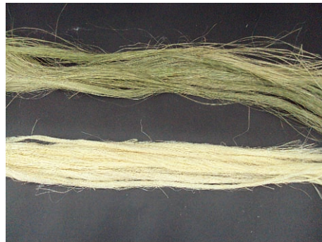
Figura 4. Fibras de formio (a) extraídas manualmente (b) extraídas químicamente
