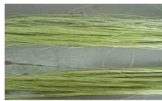
Figura 2. Fibras de formio extraídas por el método de extracción manual
