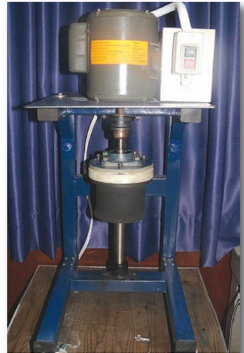
**Molino de atricción durante una prueba de funcionamiento**
