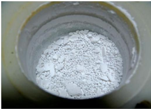
**Material cerámico a moler colocado dentro del tanque**
