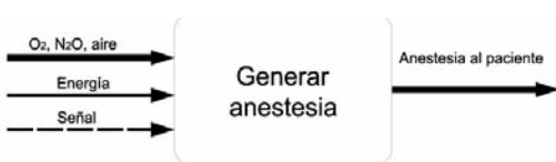
Figura 2. Diagrama funcional equipo de anestesia
