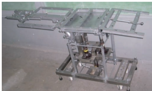
Mesa Quirúrgica Manual con el sistema de inclinación opción 2.
