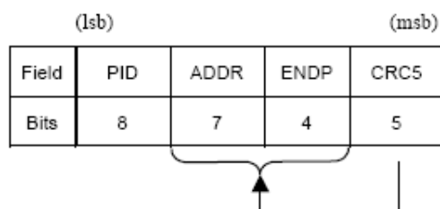
Gráfico 1-12. Formato del Paquete tipo Token. [1]
