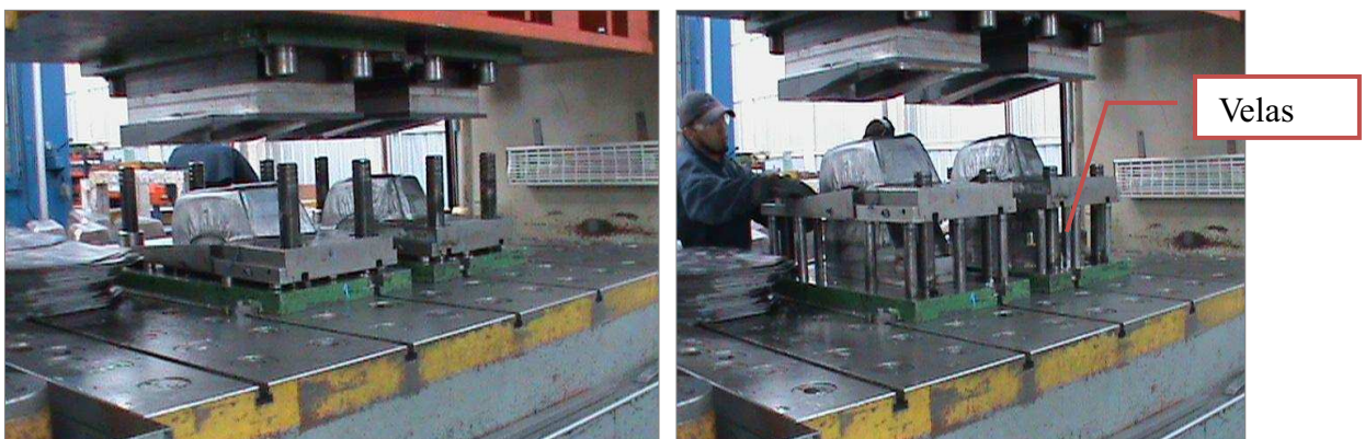
Figura 2.9 Prensa Hidráulica ROLOP 1000 toneladas (proceso embutido bóveda LH/RH)
