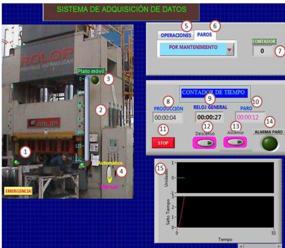
Figura 6.1 Pantalla Frontal sistema SCADA
