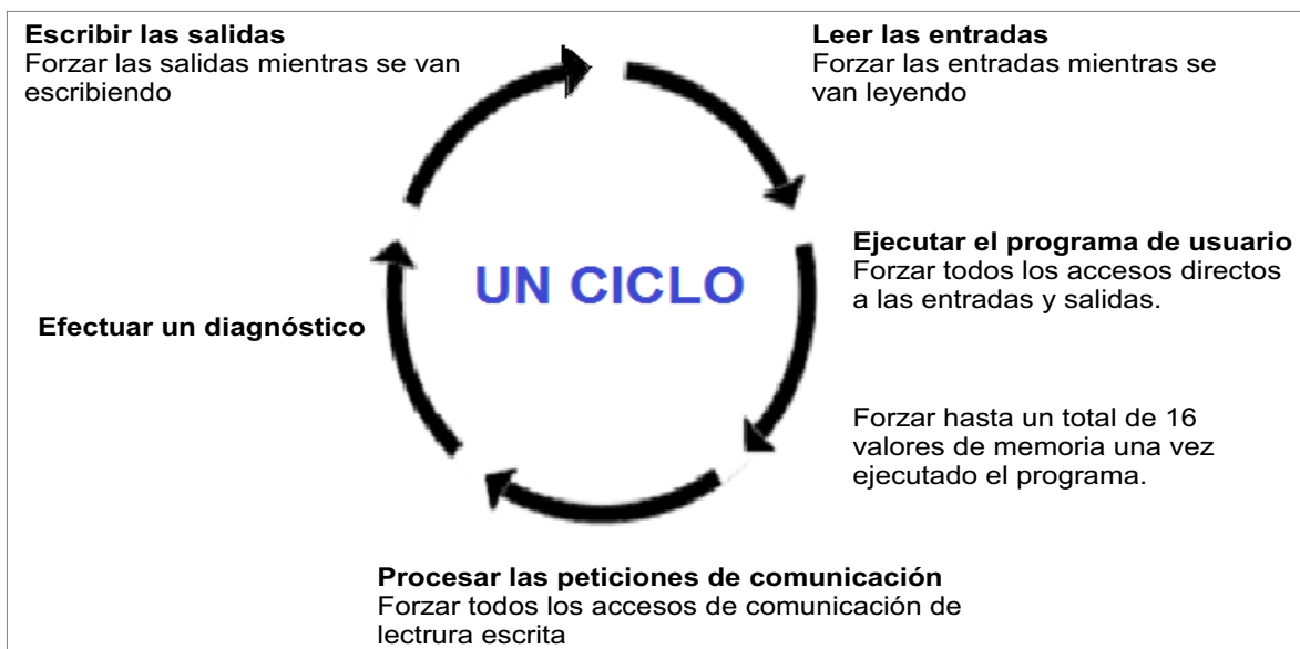
Figura 1.6 Ciclo de operación de un PLC
