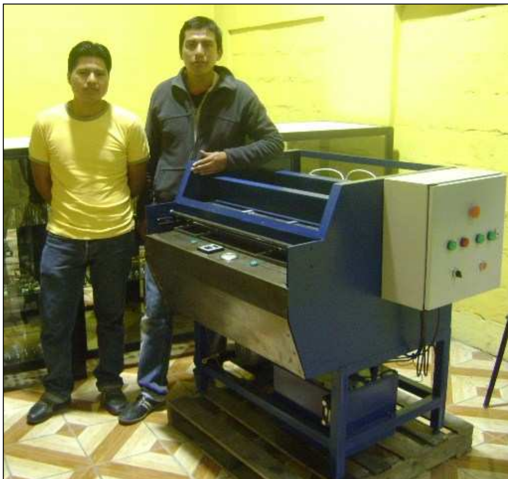
Figura 4.8. Resultado final del montaje y construcción de la formadora de cuellos y puños de camisas
