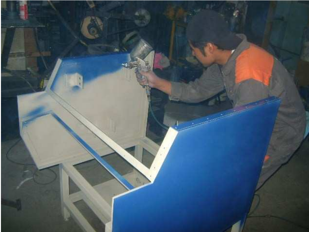
Figura A.3. Pintado del sistema estructural
