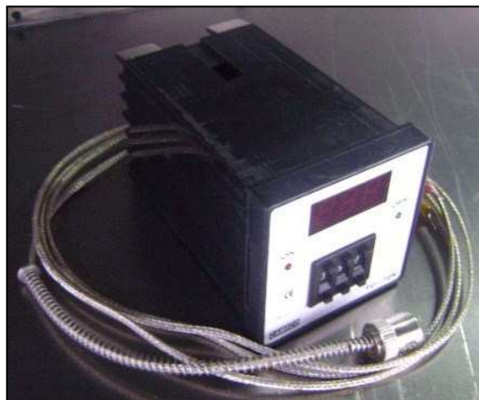
Figura 3.47. Control de temperatura
