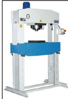
Figura 2.8. Estructura de laterales rectos.
