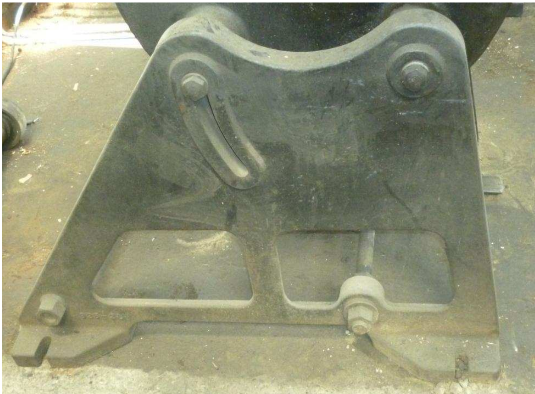
Fotografía 2.29. Estado actual del soporte derecho
