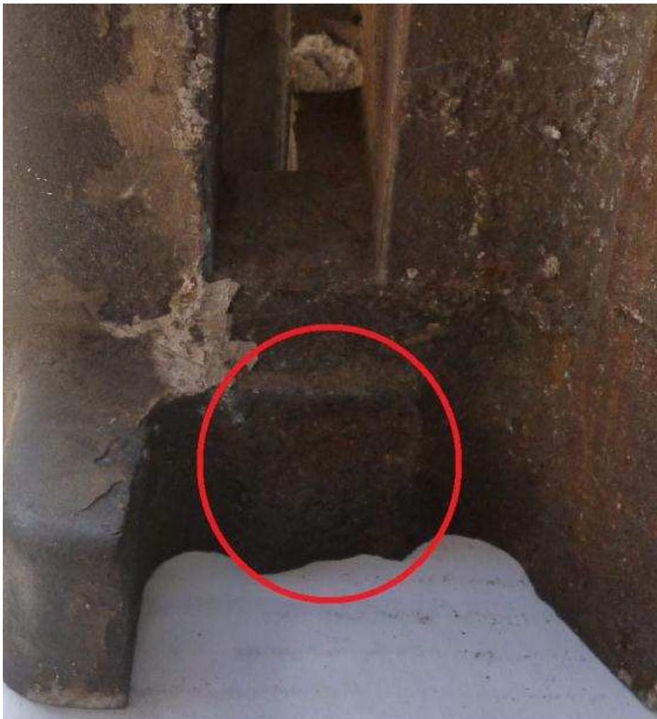
Fotografía 2.15. Zona de fractura del martillo
