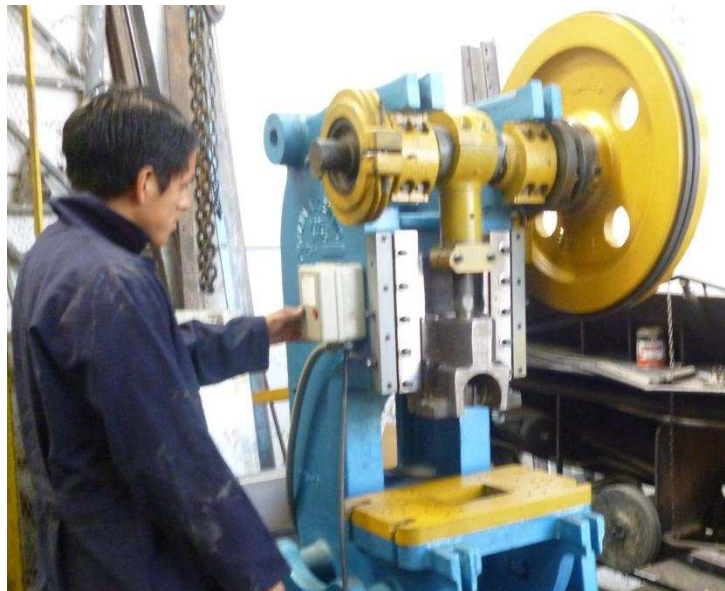
Fotografía 4.12. Montaje de la botonera
