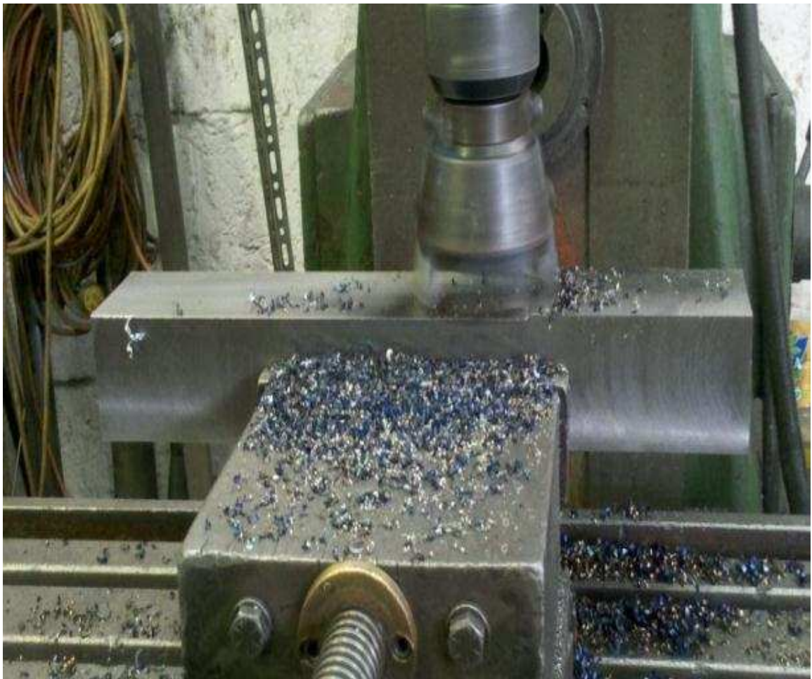
Fotografía 4.3. Maquinado de las guías (fresado).
