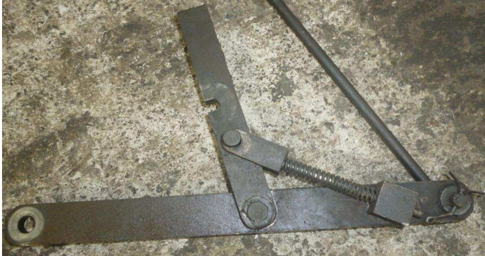
Fotografía 2.27. Estado actual del regulador del accionamiento de la cuña
