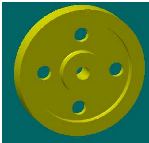
Figura 3.6. Volante de inercia
