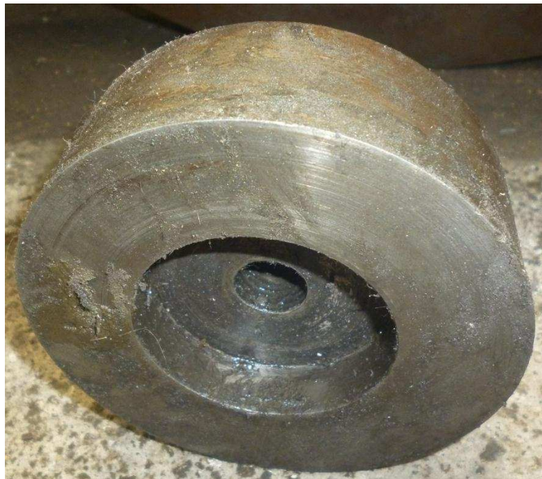
Fotografía 2.11. Estado actual de la tapa del volante de inercia
