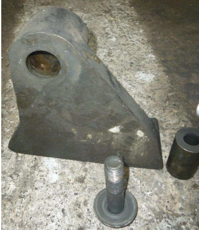
Fotografía 2.24. Estado actual de la guía superior
