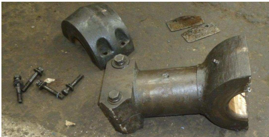
Fotografía 2.4. Estado actual de la biela, tapa y buje biela
