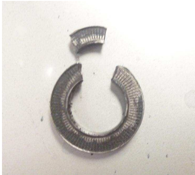
Fotografía 2.34. Estado actual de la arandela fracturada
