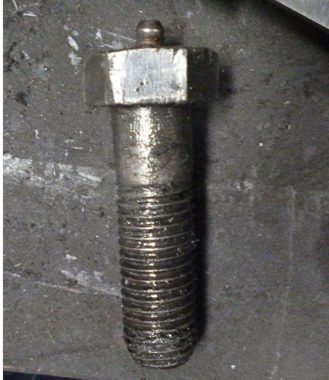
Fotografía 2.35. Estado actual del perno con graseo del volante de inercia
