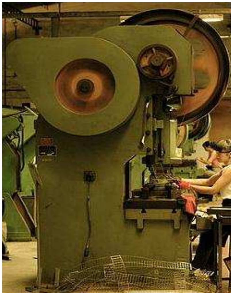
Figura 1.5. Troqueladora de dos montantes y doble biela
