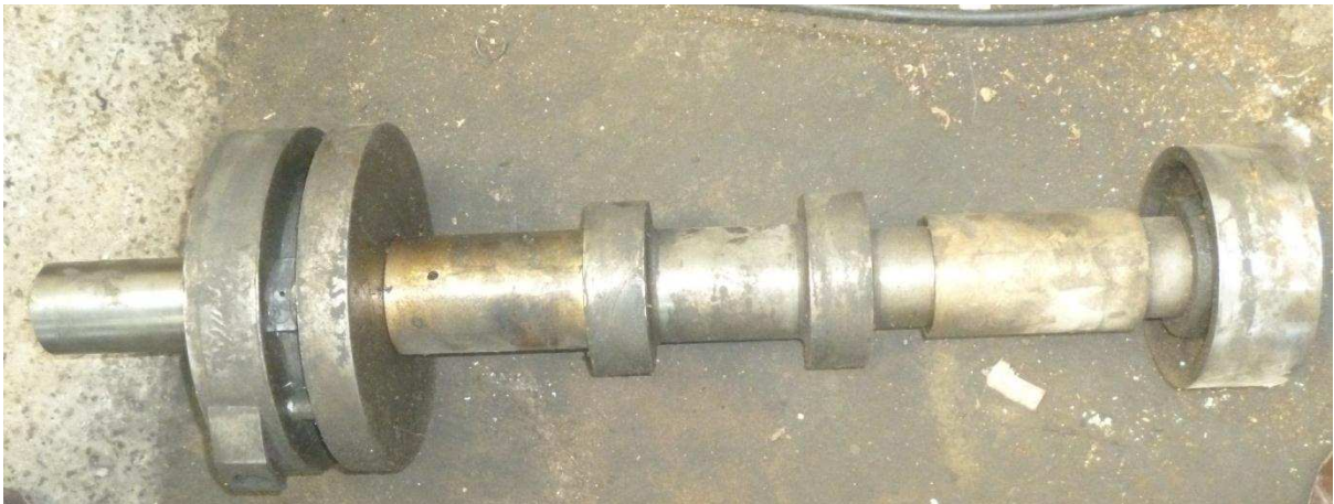
Fotografía 2.5. Estado actual del eje excéntrico, manzana y bujes
