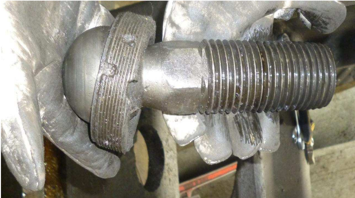
Fotografía 2.17. Estado actual del tornillo de regulación
