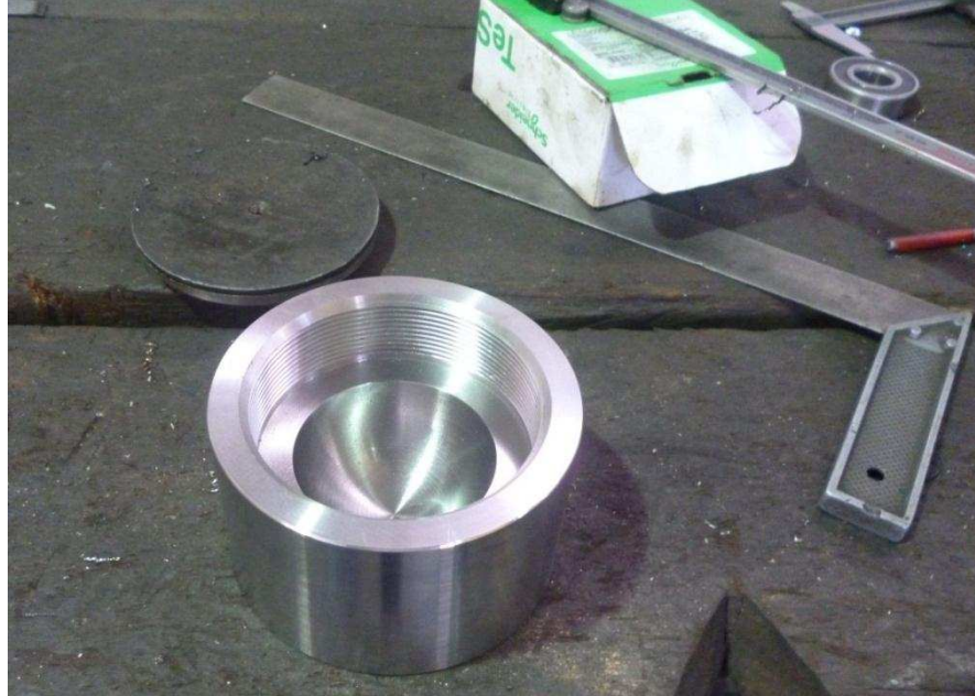
Fotografía 4.6. Verificación de medidas del inserto
