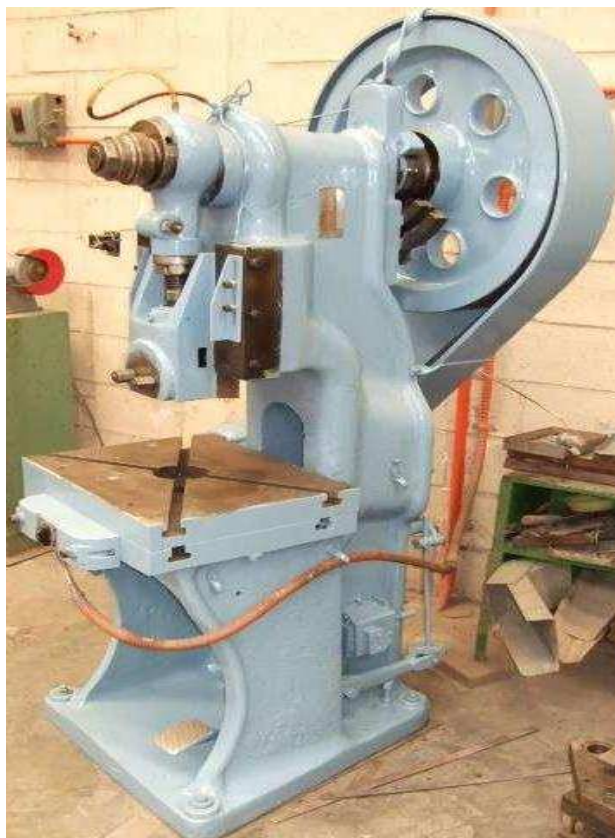
Figura 1.2. Troqueladora de excéntrica con volante frontal
