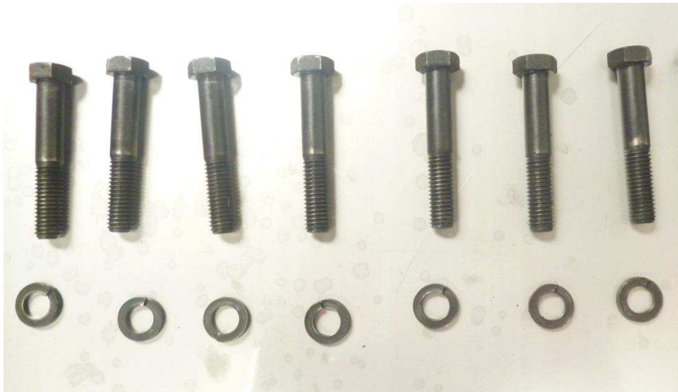
Fotografía 2.33. Estado actual de los pernos de los refuerzos de las guías laterales
