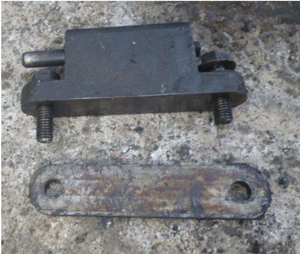
Fotografía 2.23. Estado actual del accionador de la cuña
