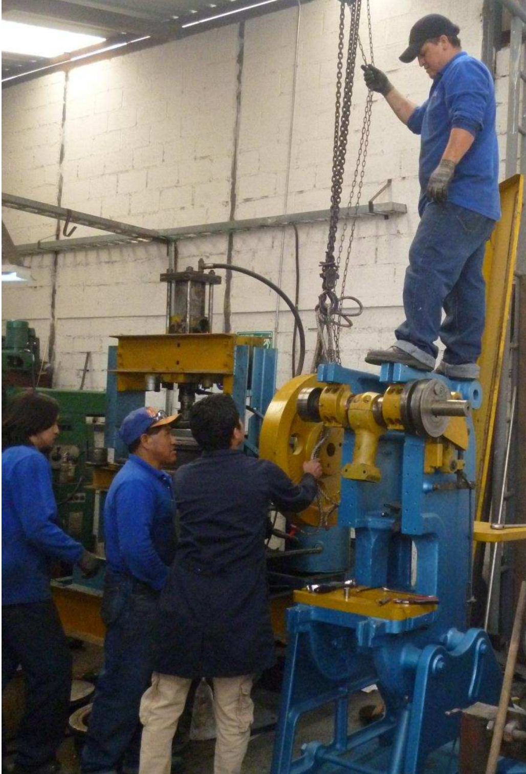
Fotografía 4.10. Montaje del volante de inercia
