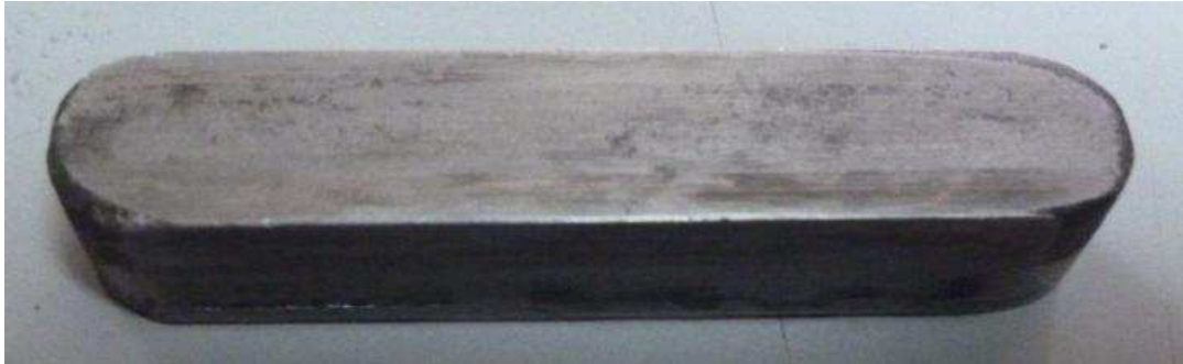
Fotografía 2.6. Estado actual de la lengüeta del eje excéntrico
