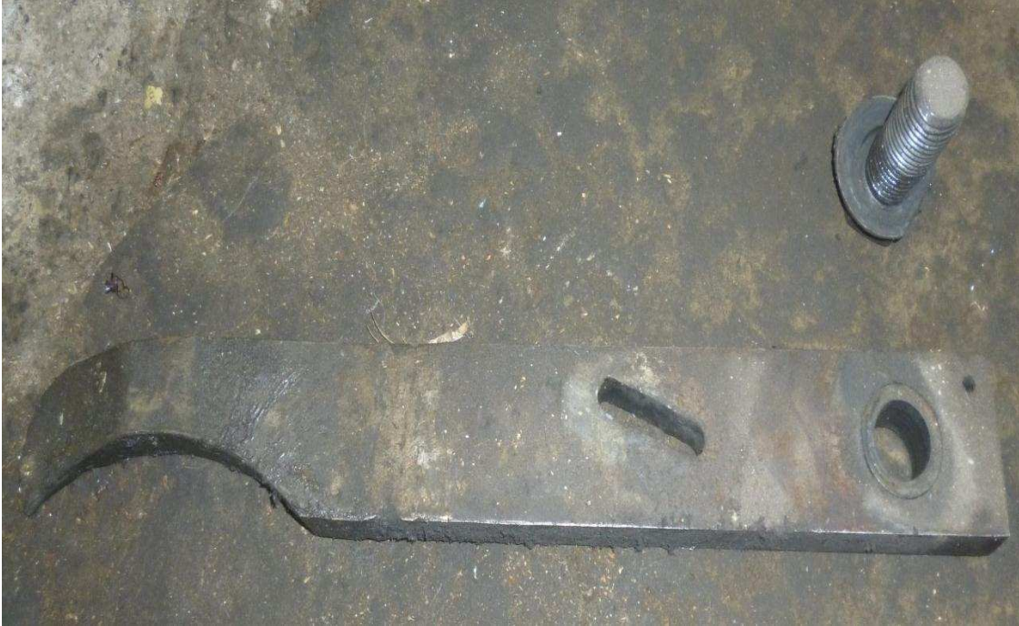
Fotografía 2.26. Estado actual de la cuña
