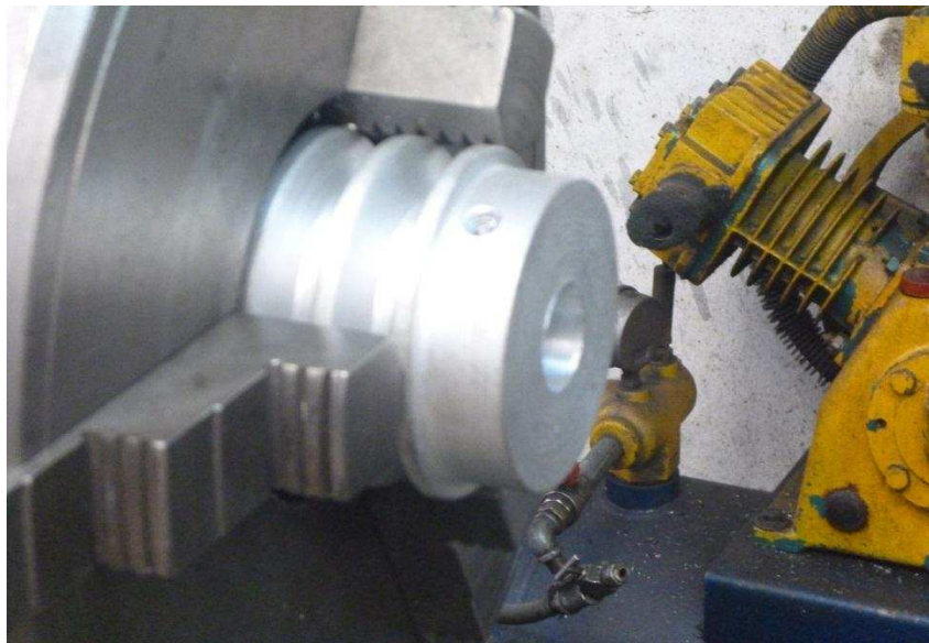
Fotografía 4.7. Maquinado de la polea (torneado)
