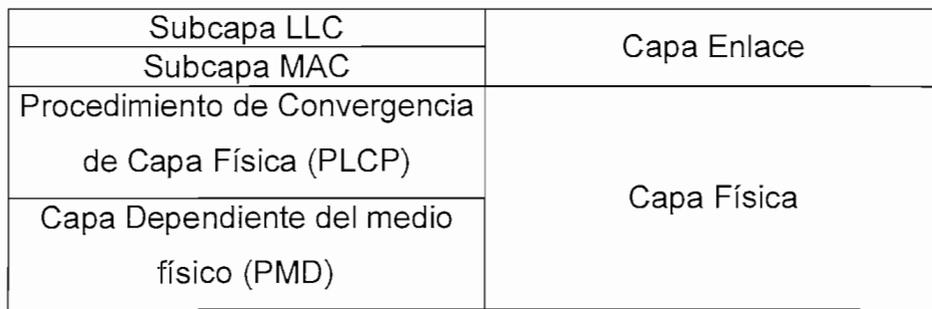
Figura 1.9.- Capas Física y Enlace de IEEE 802.11
