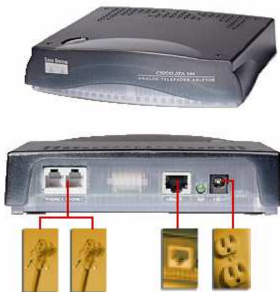
Figura 1.6 Interfaces en un adaptador o gateway (Cisco)
