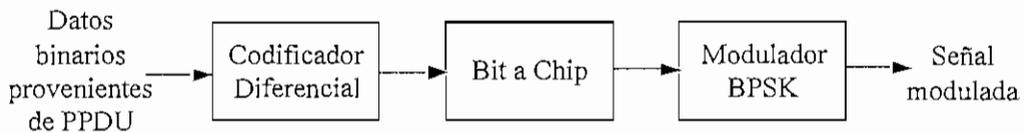
Figura 1.22 Funciones de modulación y propagación.
