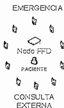
Figura 2.25 Red de Sensores ZigBee
