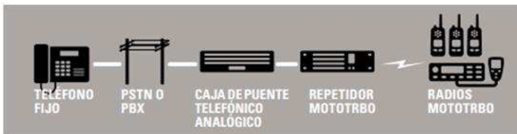
Figura XX.46 Esquema conexión del APP.
