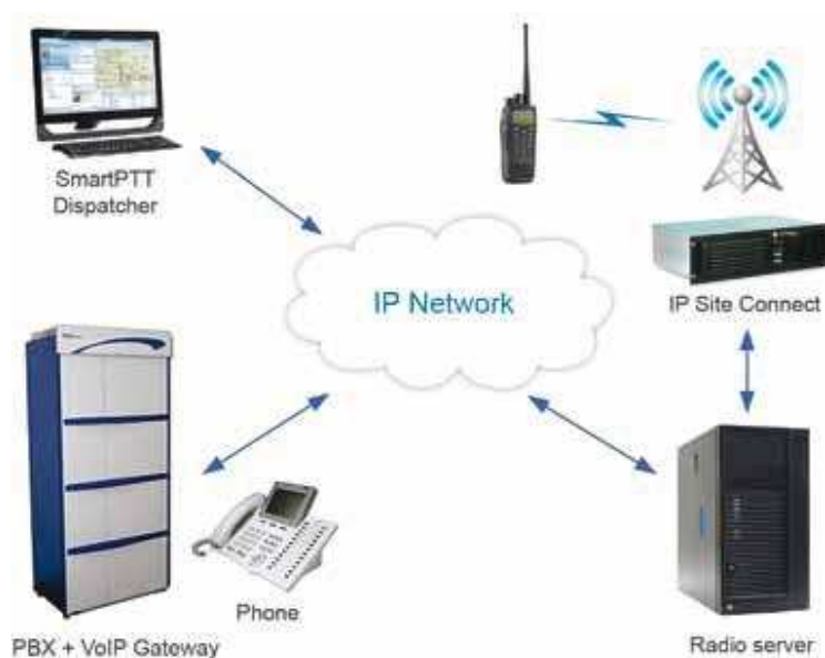
Figura XX.52 Esquema de interconexión con la telefonía mediante SmartPTT.
