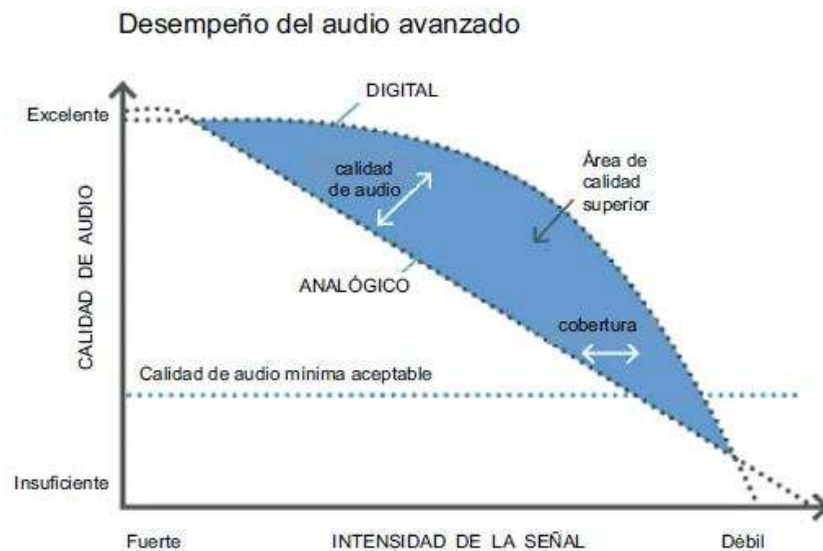
Figura XXI.4 Comparación entre el desempeño del audio analógico y el digital
