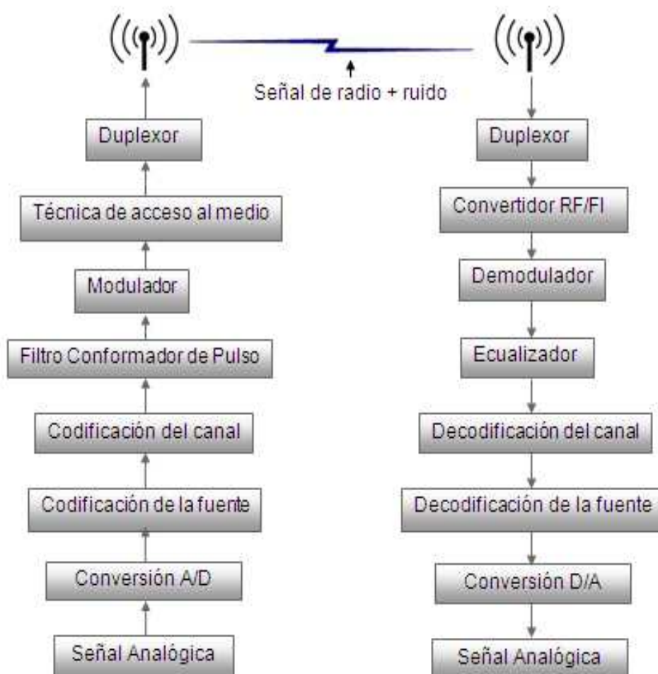
Figura XX.1 Diagrama Sistema VHF Digital.
