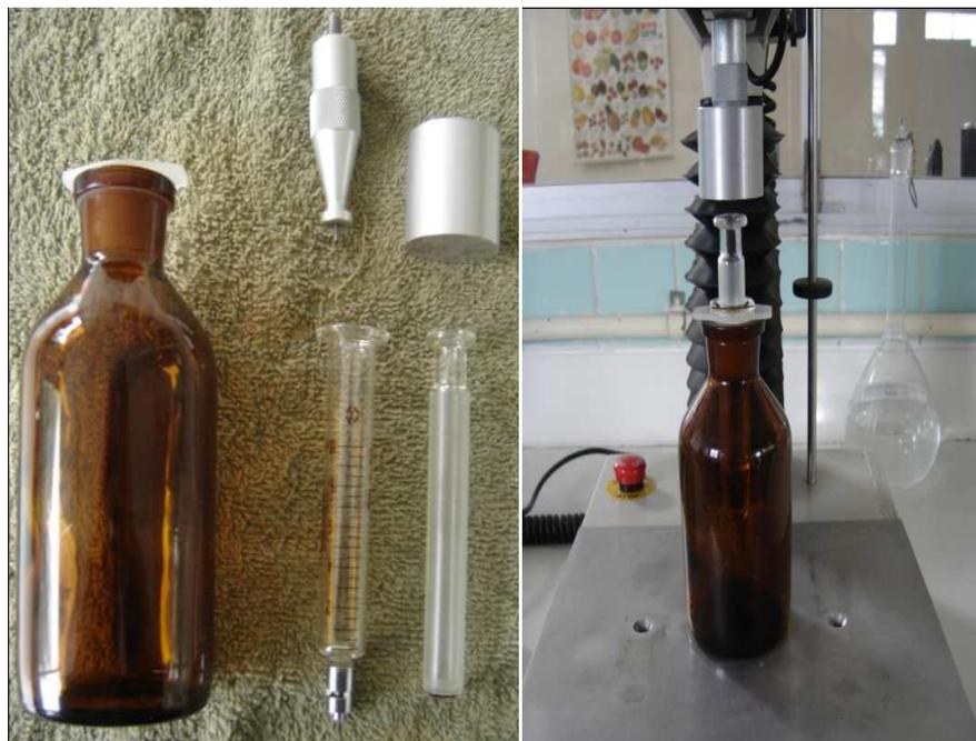
**Figura 8.** En la izquierda se presentan los accesorios utilizados para medir la viscosidad, en la derecha se presenta el texturómetro TA-XT2i y accesorio utilizados para la medición instrumental de la viscosidad de la miel de camote
