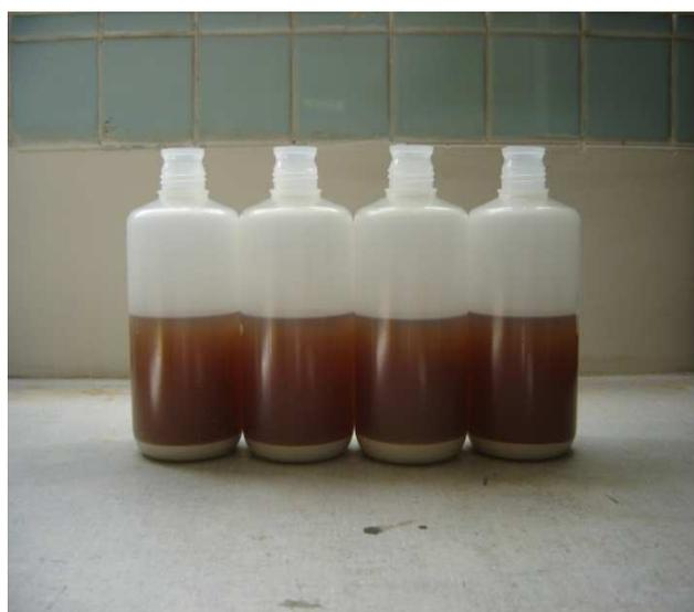
**Figura 5.** Mucílago separado por centrifugación del extracto líquido hidrolizado
