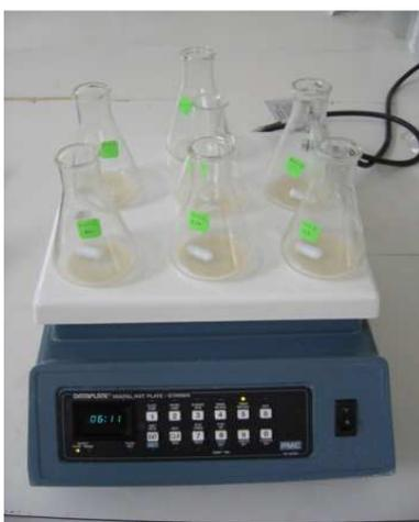
**Figura 26.** Extracción de la muestra para determinar poder antioxidante
