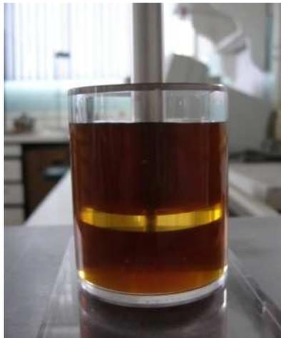
**Figura 29.** Proceso que realiza el texturómetro TA-XT2i con el accesorio de extrusión, en la medición de consistencia
