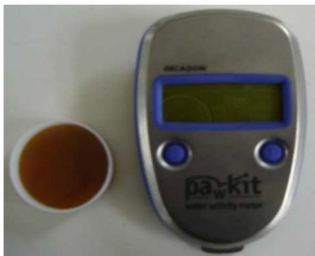
**Figura 7.** Medidor de actividad de agua marca AQUALAB
