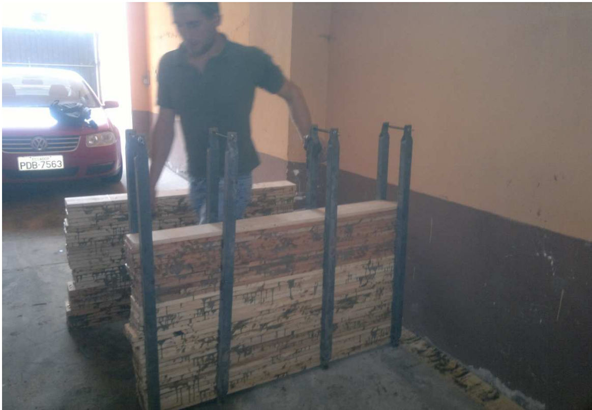
FOTOGRAFÍA 7. Prensado de las probetas pegadas y pegadas más clavos
