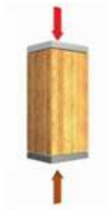
Figura 2.1. Compresión paralela a las fibras
