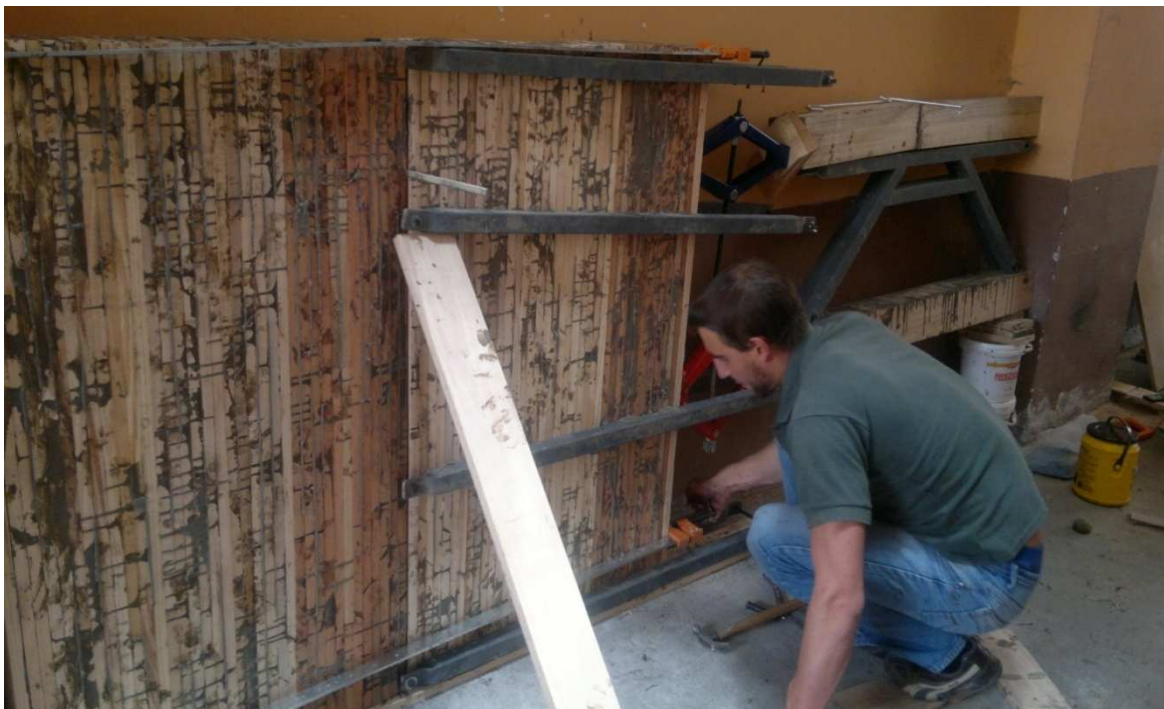
FOTOGRAFÍA 7. Prensado de las probetas pegadas y pegadas más clavos
