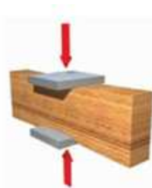
Figura 2.2. Compresión perpendicular a las fibras
