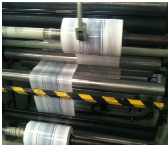
Figura 2.16 Eje y rodillos del bobinador COMEXI Elaborado por: Lucas Infante y Fredy Cabascango
