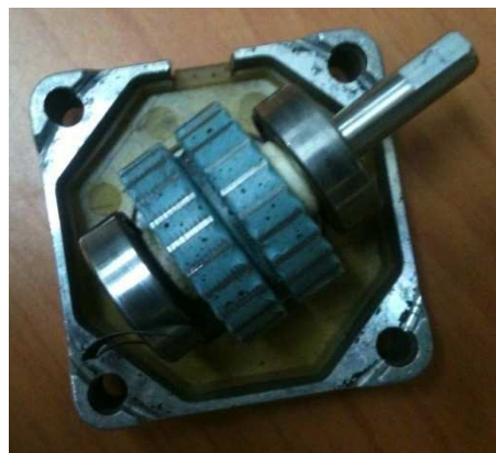
Figura 2.41 Imagen del rotor el motor paso a paso Fuete: http://www.superrobotica.com/S330300.htm
