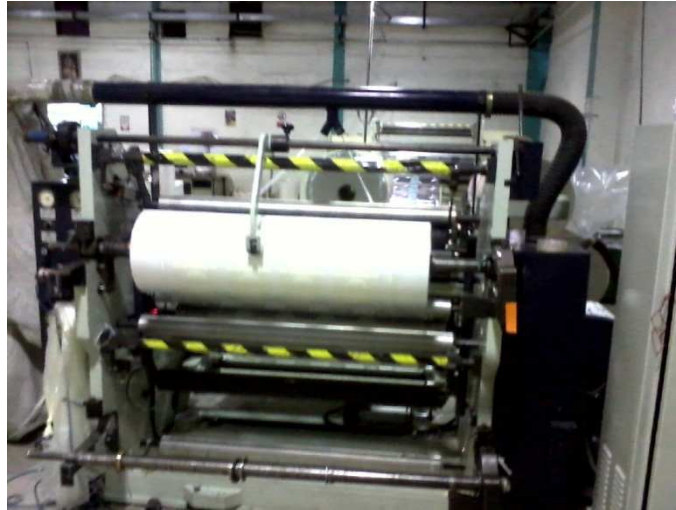
Figura 2.62 Bobinadora rehabilitada y en funcionamiento
