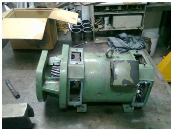
Figura 2.8 Motor de la bobinadora COMEXI-estado inicial
