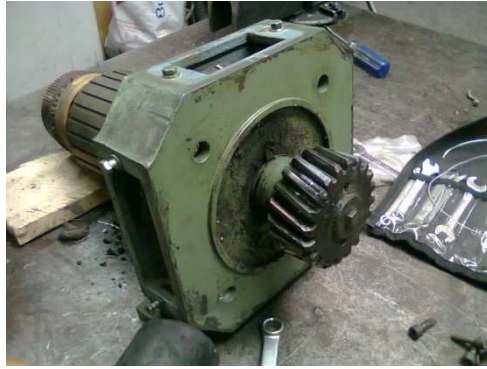
Figura 2.10 Colector y rodamientos del motor Elaborado por: Lucas Infante y Fredy Cabascango
