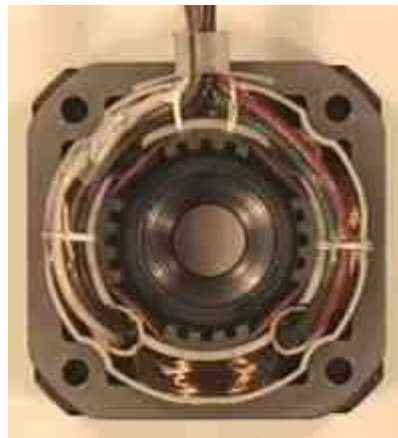
Figura 1.29 Imagen de un estator de 4 bobinas
