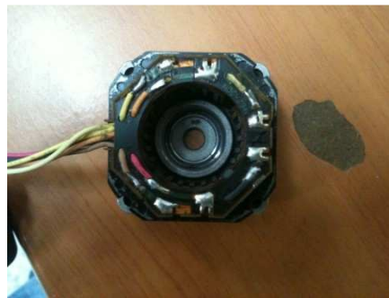
Figura 2.40 Imagen de un estator de 4 bobinas Fuete: http://www.superrobotica.com/S330300.htm
