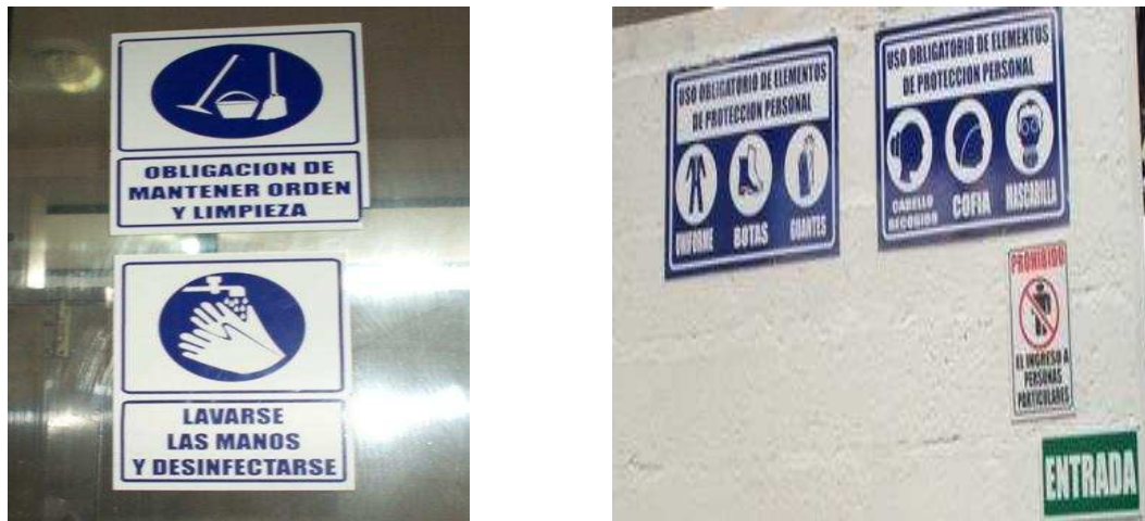
Figura 3.7. Colocación de las señales de obligatoriedad, prohibición y seguridad industrial
