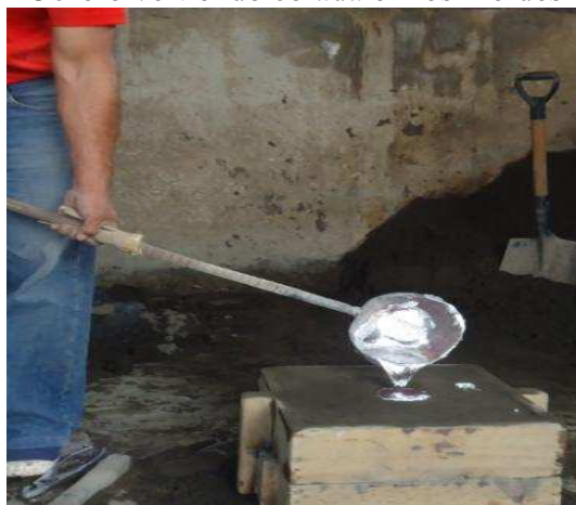
Obrero vertiendo colada en los moldes
