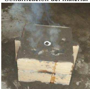
Solidificación del material
