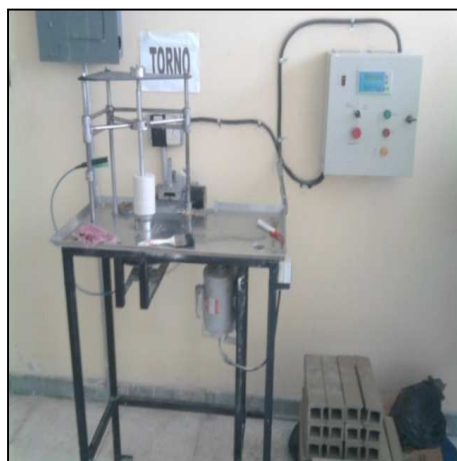
Fig. 1.12 Torno mecánico automático de formado de aisladores y bujías
