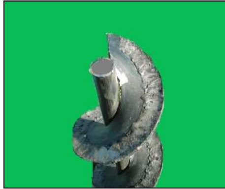
Fig. 3.9 Falla por defectos de fabricación
