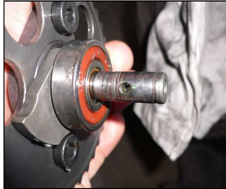
Fig. 3.11 Desgaste natural de un eje.
