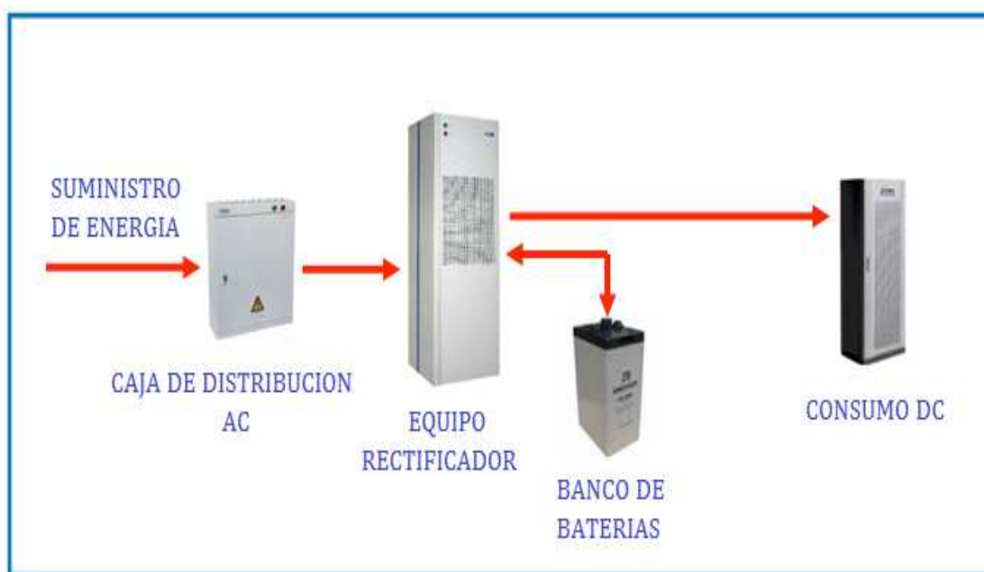
Figura 3.41 Sistema de Rectificación de Energía AC/DC
