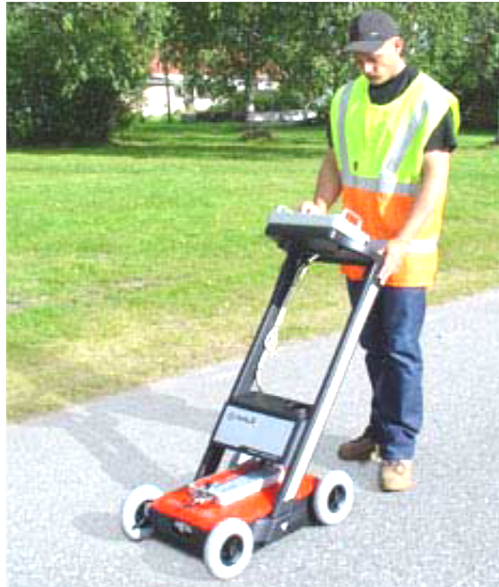
Figura 1.66: Estudio del suelo con georadares. [9]
