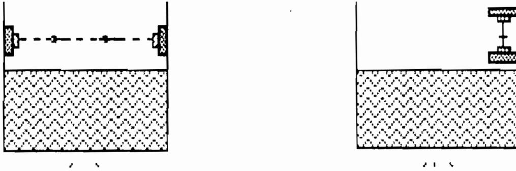
Figura 6.7 Determinación de nivel por elementos fotoeléctricos
