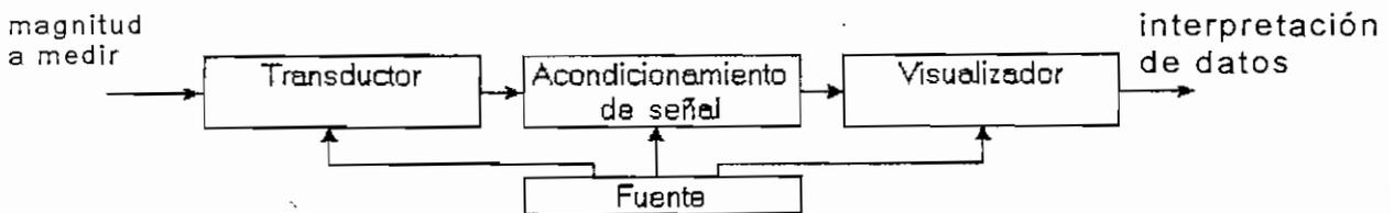
Figura 1.1 Sistema electrónico básico de medición
