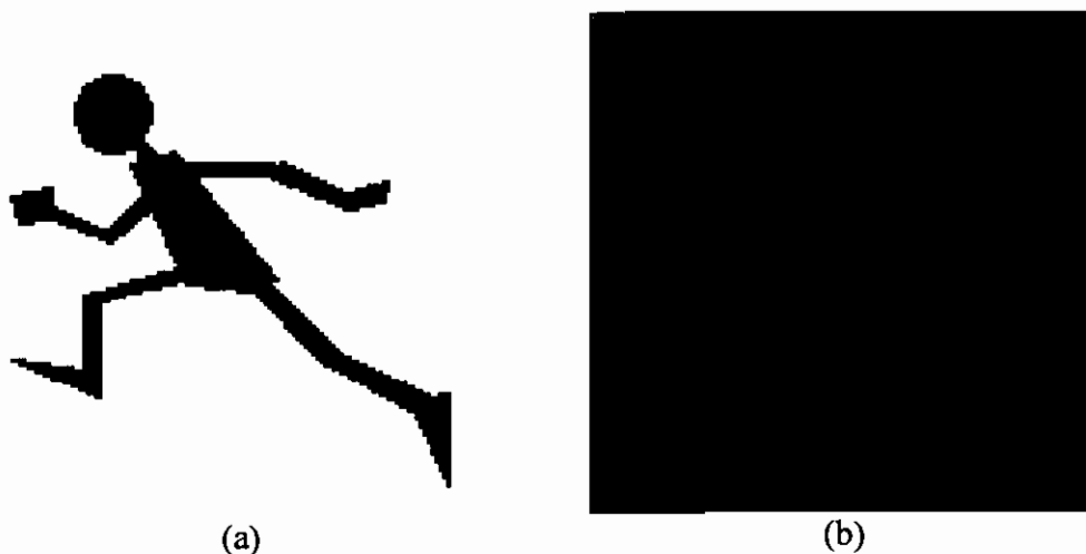
Figura 3.3.0.11 (a) Imagen en dominio espacial. (b) Imagen que representa el espectro de la imagen mostrada en (a).
