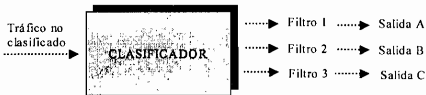
Figura 4.5 Diagrama de un clasificador. [34]
