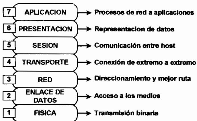
Figura 1.4. Las 7 capas del modelo de referencia OSI
